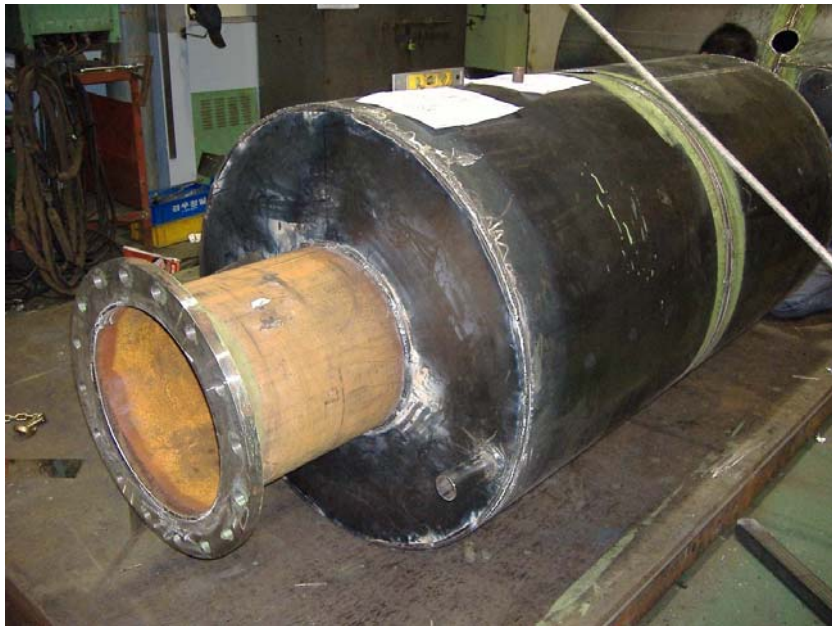
그림 68 PCM 열교환부의 열매체유조와 축열물질조의 외관
