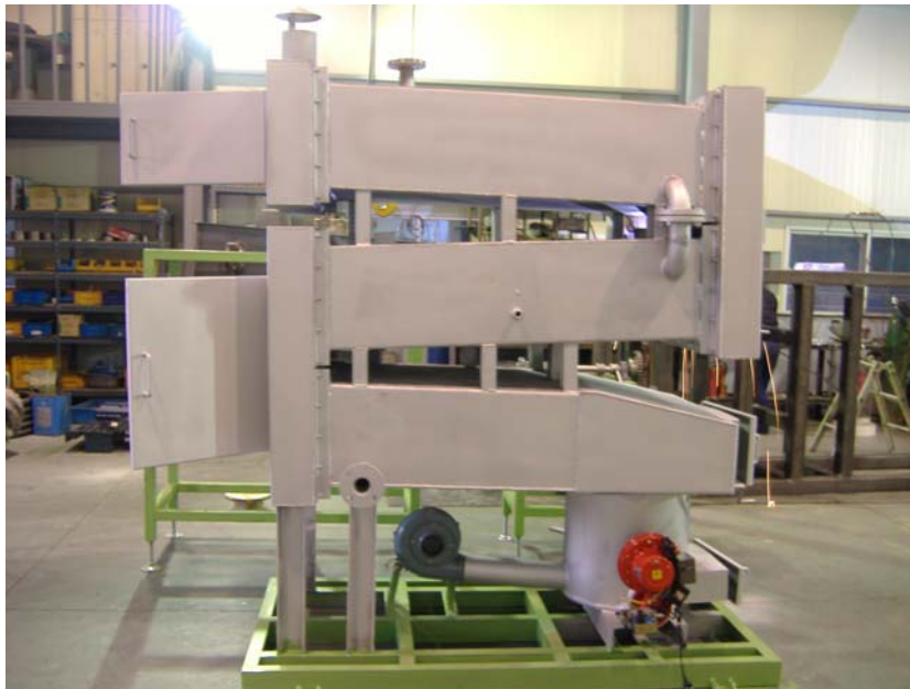
그림 64 석탄보일러의 외부 모습(정면)
