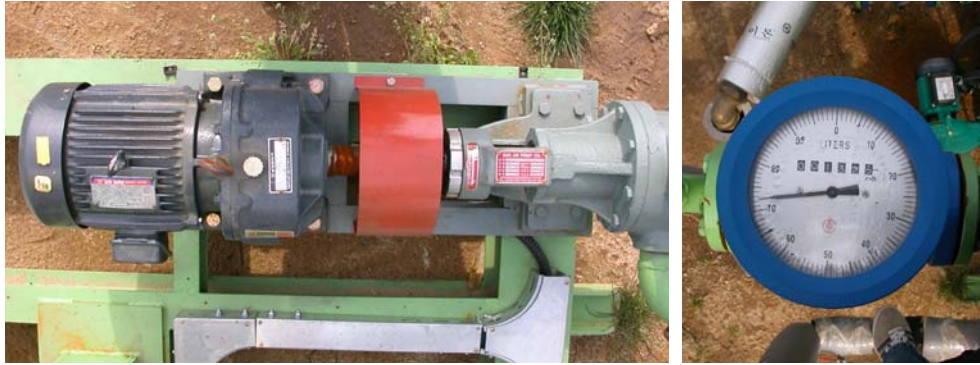
그림 87 시작기에 적용된 열매체유 펌프 및 고온고압용 유량계
