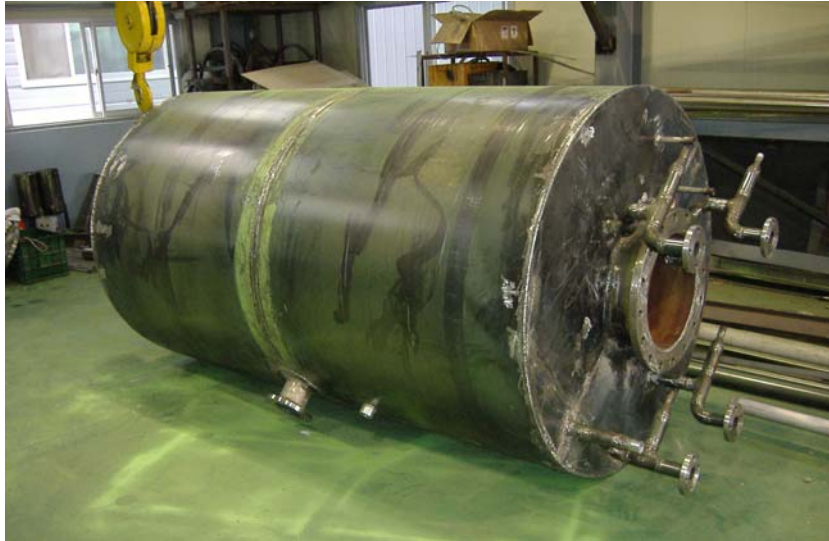
그림 70 PCM열교환부의 조립된 외관 모습
