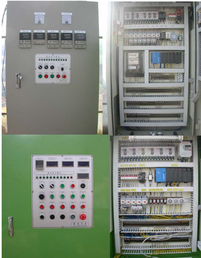
그림 77 시작기 제어부의 내·외관 모습
