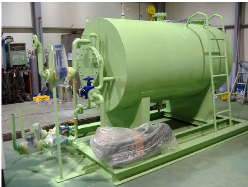
그림 71 PCM열교환부의 펌프 및 유량계를 부착한 모습
