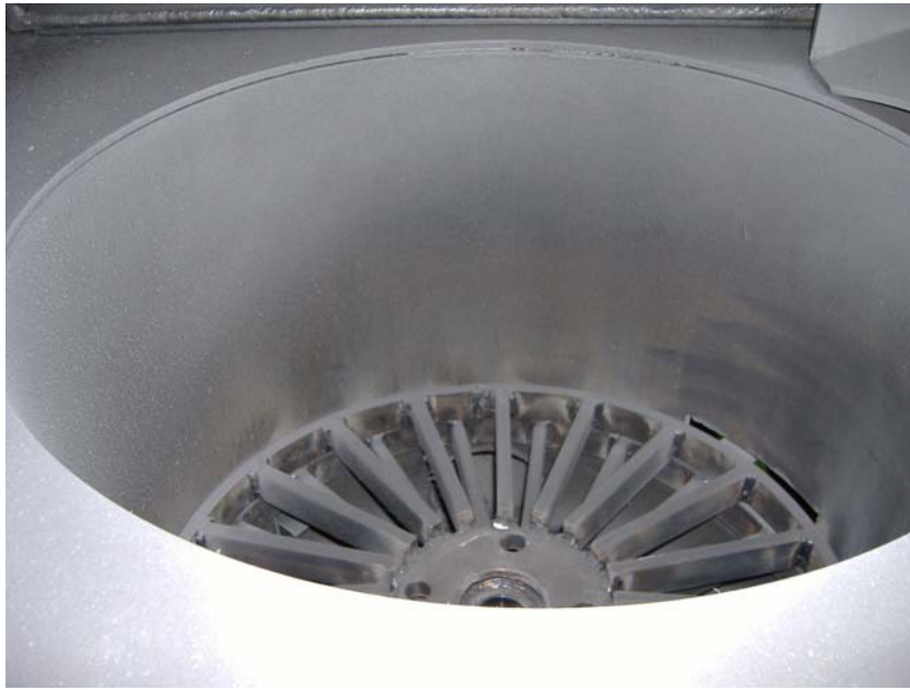
그림 46 발열부의 연소실 및 화격자의 형상
