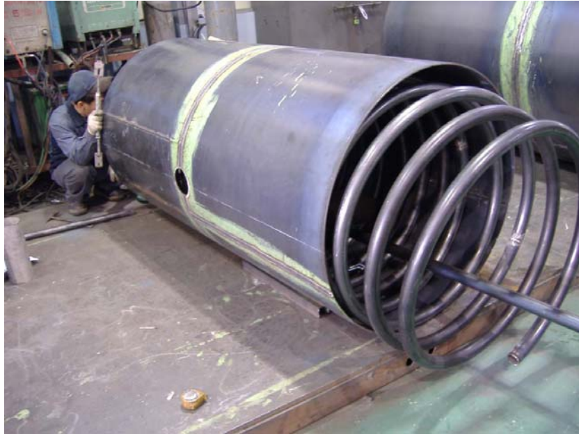
그림 67 PCM 열교환부의 축열물질조 및 열매체유 열교환 파이프
