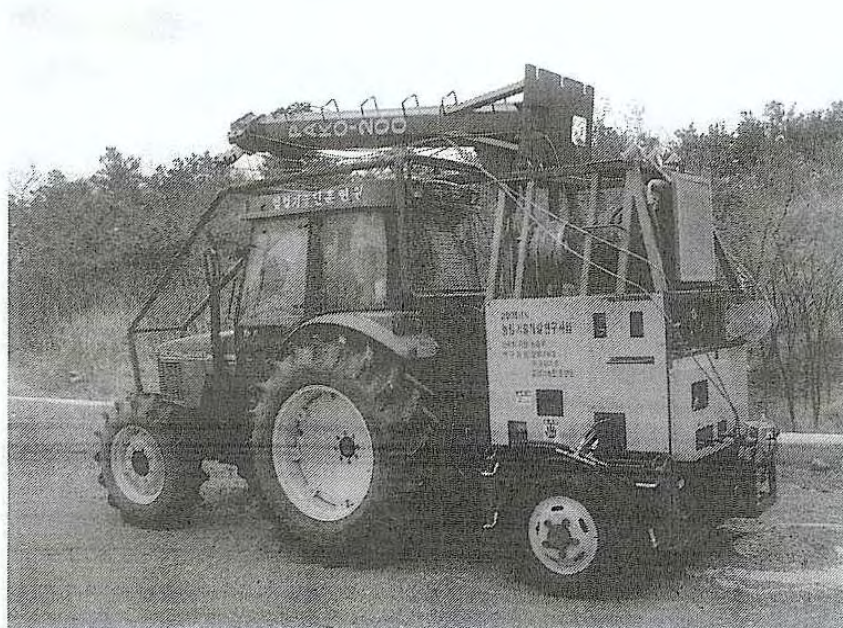
그림 3-33. 조사에 사용된 트랙터부착형 타워집재기
