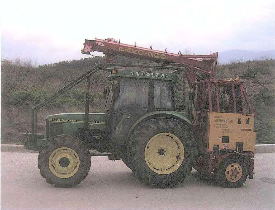
그림 3-31. 트랙터 부착 타워집재기(모델명 PAKO-200) 완성 모습
