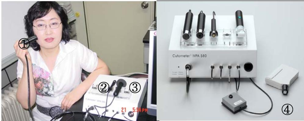
① Cutometer, 탄성측정용 probe, ② Coneometer, 보습도 측정용 probe, ③ Mexameter, 멜라닌/홍반 측정용 probe, ④ Sebumeter, 유분측정용 카세트.
