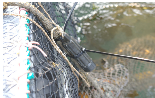
가두리내 자동수온로거장치 설치
