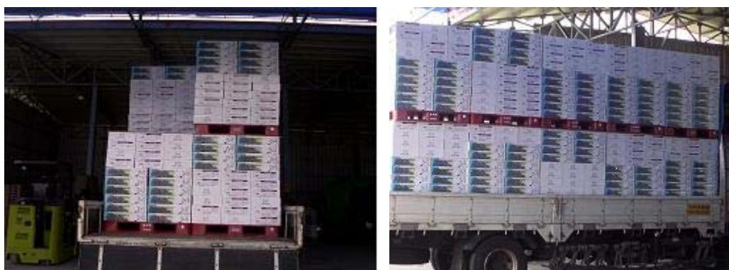
Figure 4. 수송용 트럭(5톤 차량)에 파렛트 2단 적재된 상태
