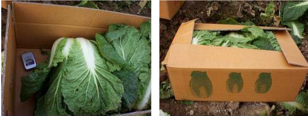
Figure 49. 배추상자의 온습도 측정을 위한 측정기 부착 및 포장상태
