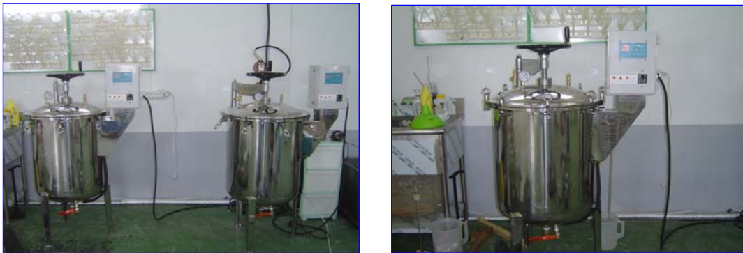
그림 40. 길항세균 대량배양을 위하여 자체 제작한 발효기(200 L)
