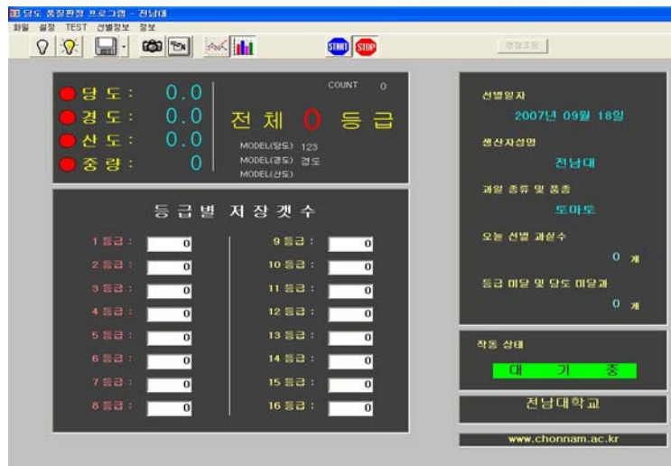
그림 6-3 토마토 내부품질과 중량의 실시간 측정 및 선별용 소프트웨어의 주요 화면
