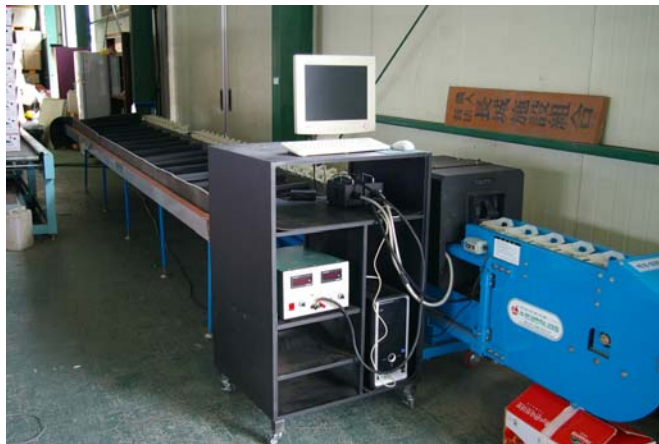
그림 6-1 실증실험용으로 제작한 보급형 선별기의 시작기
