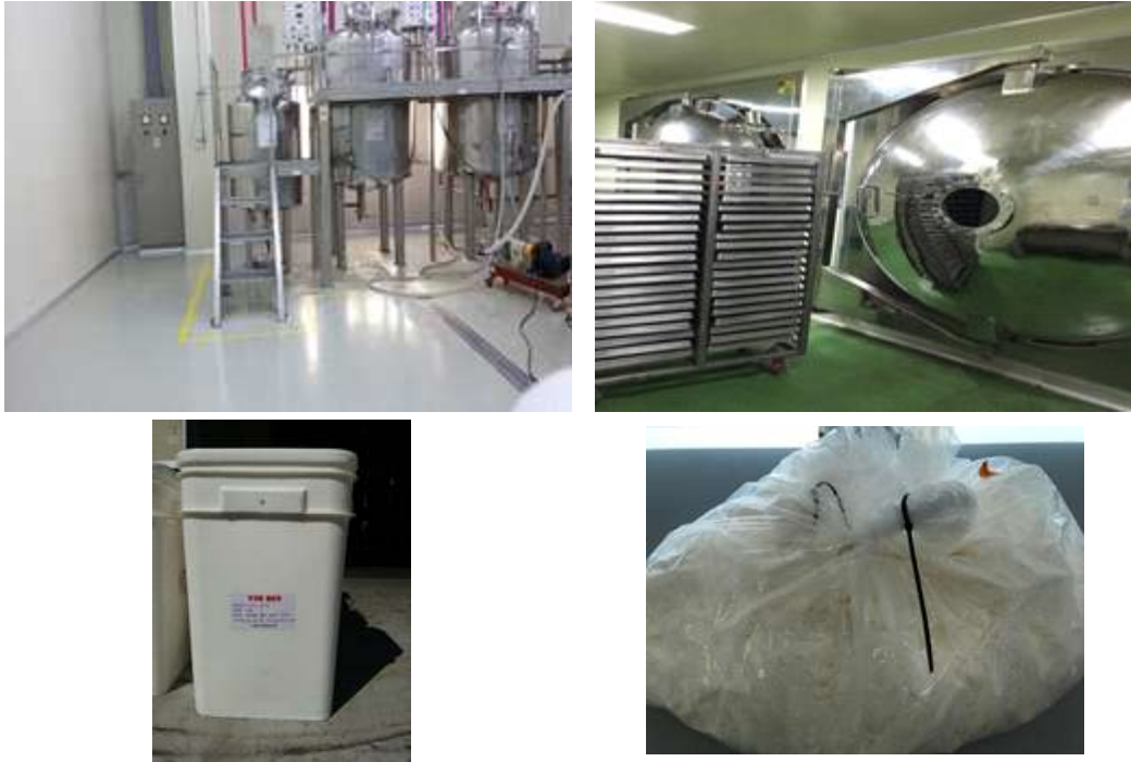
그림 1-39. 신바이오틱스 고농축 발효액 제조 설비 및 제품 - 배양탱크, 동결건조기
