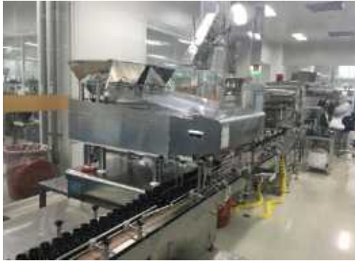
그림 1-41. 신바이오텍스 캡슐 제제 제조 설비 및 제품 - 하드캡슐 충전기, 선별기, 병포장기
