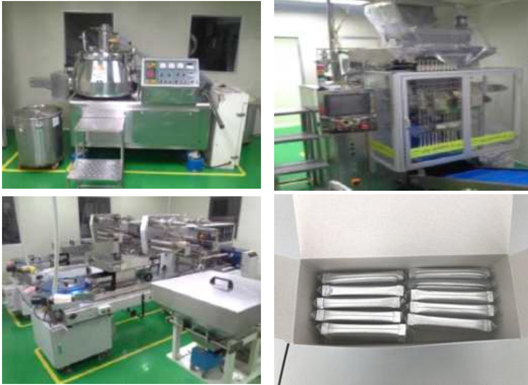
그림 1-40. 신바이오텍스 분말 제제 제조 설비 및 제품 - 혼합믹서, 스틱 충전기, 자동포장기
