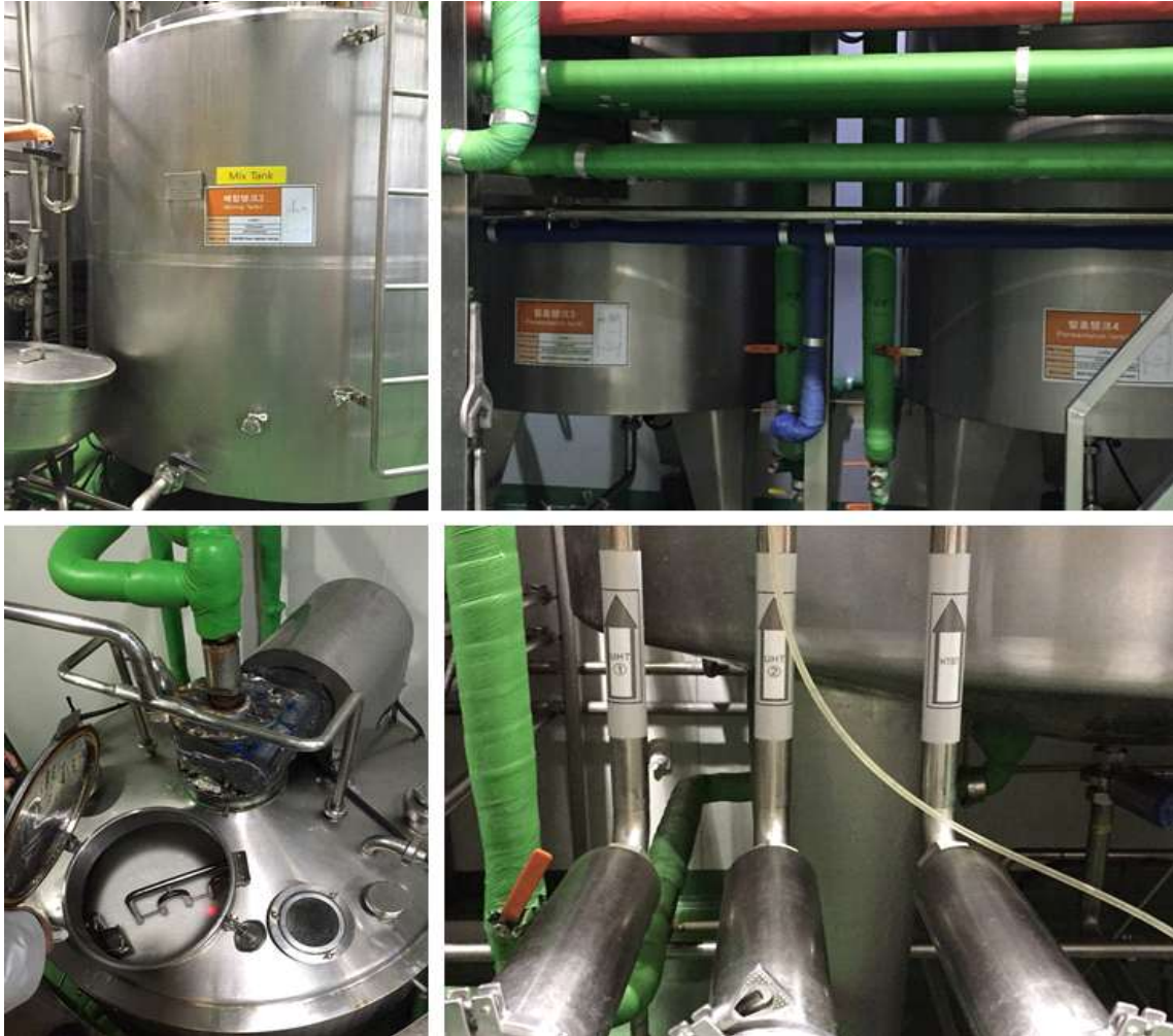
그림 1-36. 신바이오틱스 발효유의 pilot scale 제조 공정 (왼쪽 위: 배합탱크, 오른쪽 위 발효탱크, 왼쪽 아래: 혼합, 오른쪽 아래: 살균)
