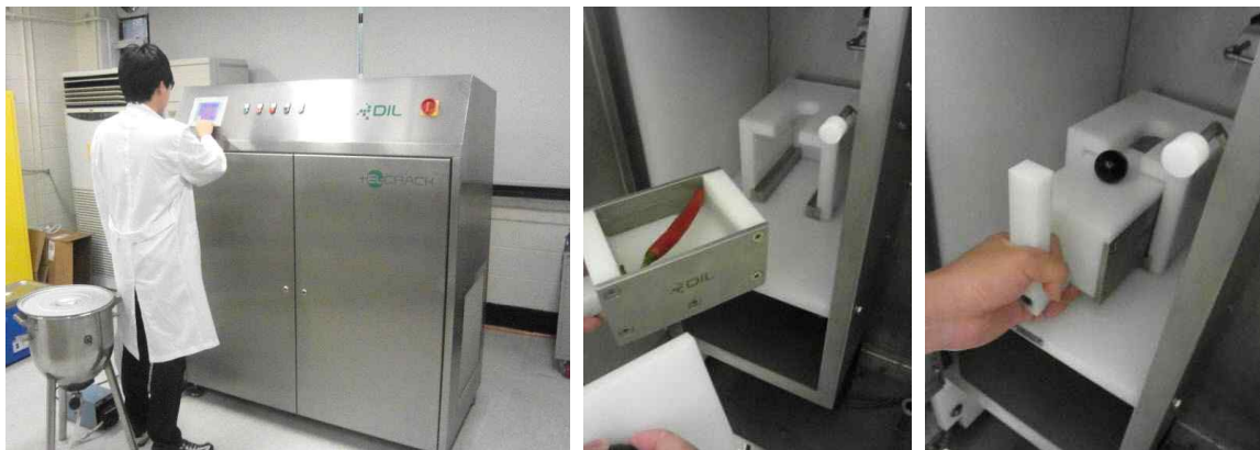
Fig. 8. PLC를 이용해 펄스 제네레이터에 조건을 설정 (그림 좌); 처리 할 홍고추를 회분형 처리조(그림 중간)에 넣은 후 펄스 제네레이터에 장착하는 모습 (그림 우)
