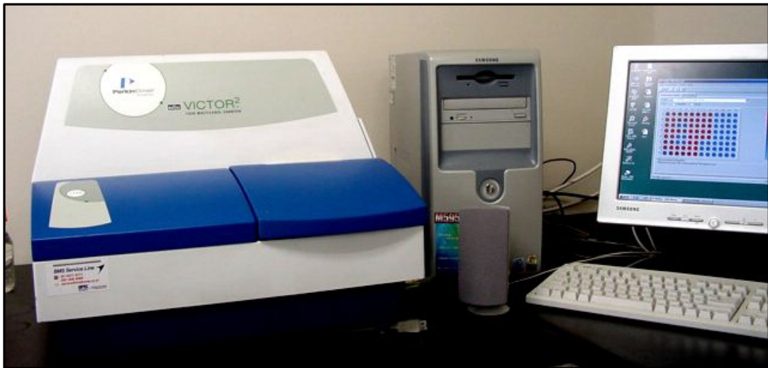
<그림 3-4-1>. Chip 실험용 DNA 농도 측정 시스템 (Fluorometer)
