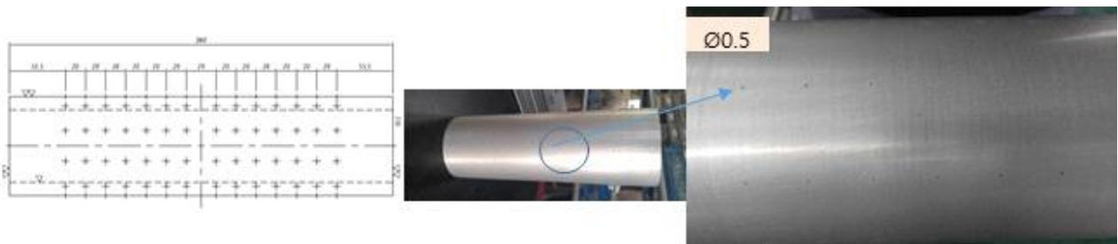
그림 45 2차 파종 드럼의 앞면 설계 및 드럼 앞면 사진
