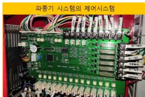
그림 105 파종시스템 전용의 제어기 및 소프트개발
