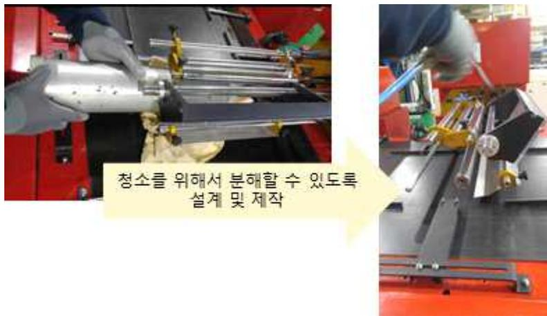
그림 104 드럼의 교체 및 청소를 위한 탈부착이 가능하도록 설계 및 제작
