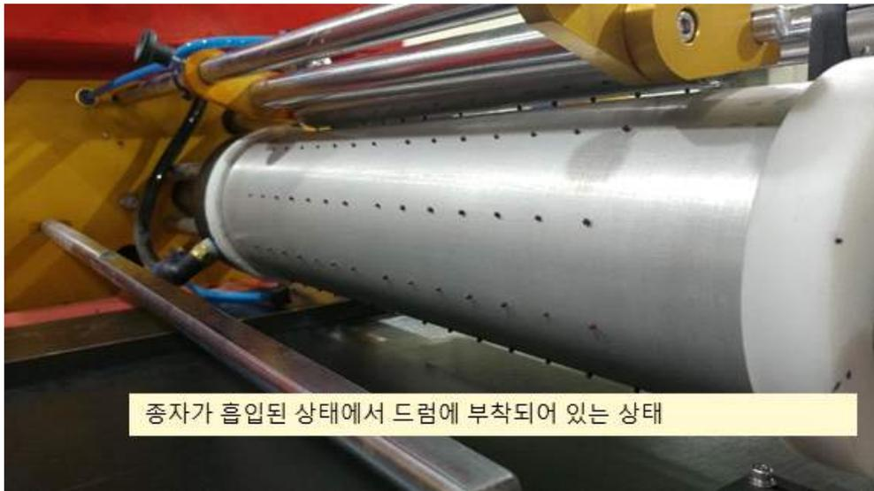
그림 110 드럼에 균일하게 흡입되어 있는 종자의 상태
