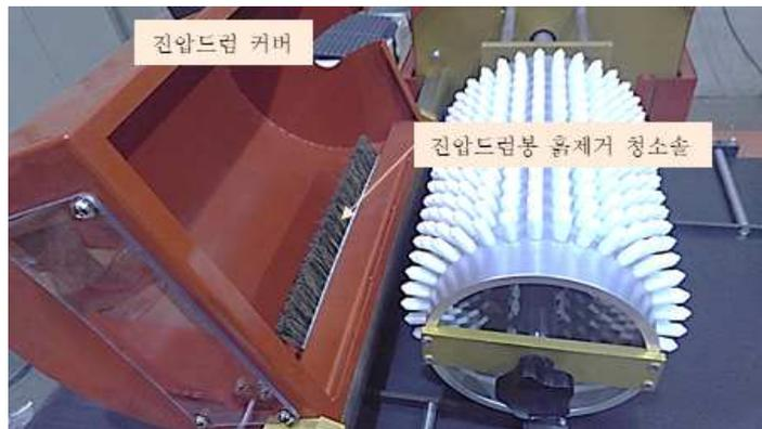
그림 32 드럼타입 고속 진압봉 흙 제거 청소솔 및 커버
