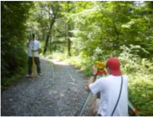
그림 3-3-22. 노면조도 측정을 위한 레벨 측량
