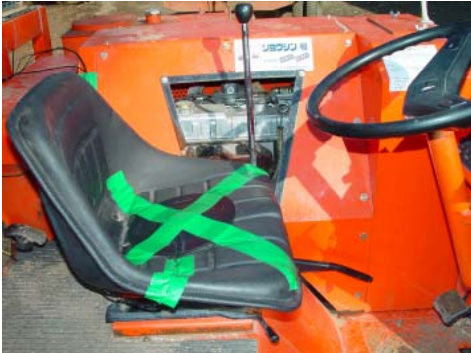
그림 3-1-20. 3축 좌석진동계(Type 4322)의 설치모습.
