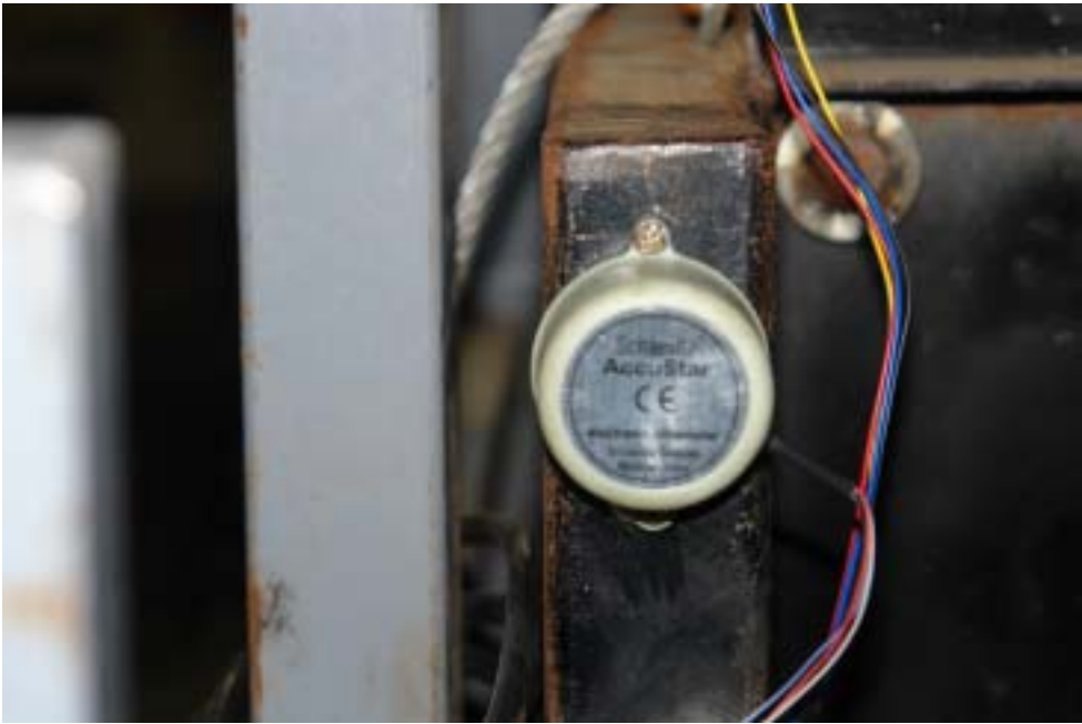
그림3-1-33. 차체의 경사각 측정을 위한 경사계의 설치
