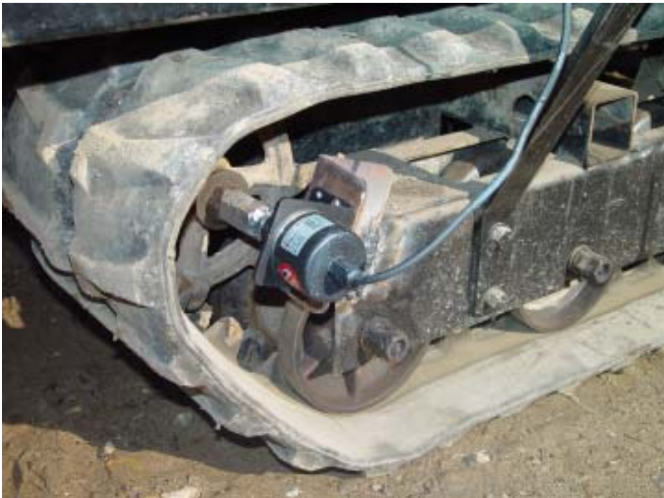
그림 3-1-28 주행속도 측정을 위한 로타리 엔코더의 설치
