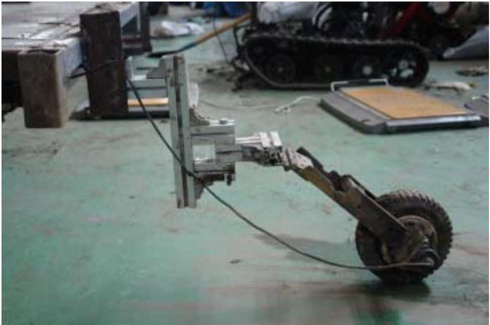
그림 3-1-34. 차량의 주행속도 측정을 위한 제 5 룬의 설치
