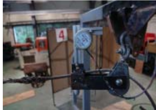
(b) 견인줄 각도 측정을 위한 각도센서
