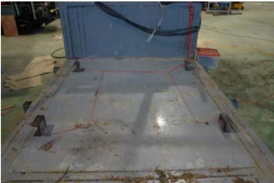
그림 3-1-30. 적재 중량 측정을 위한 스트레인 게이지의 배열
