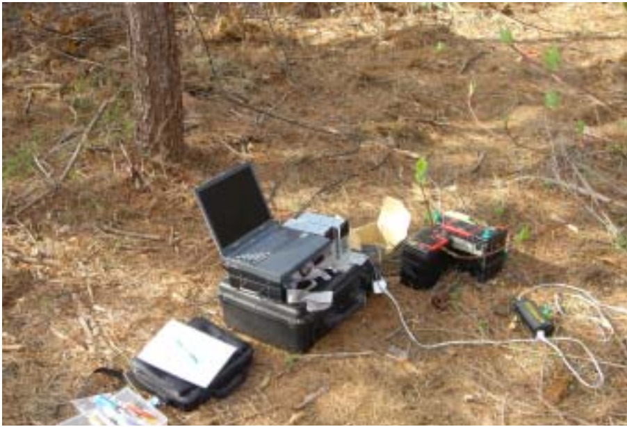
그림 3-1-45. 장력측정을 위한 자료수집장치
