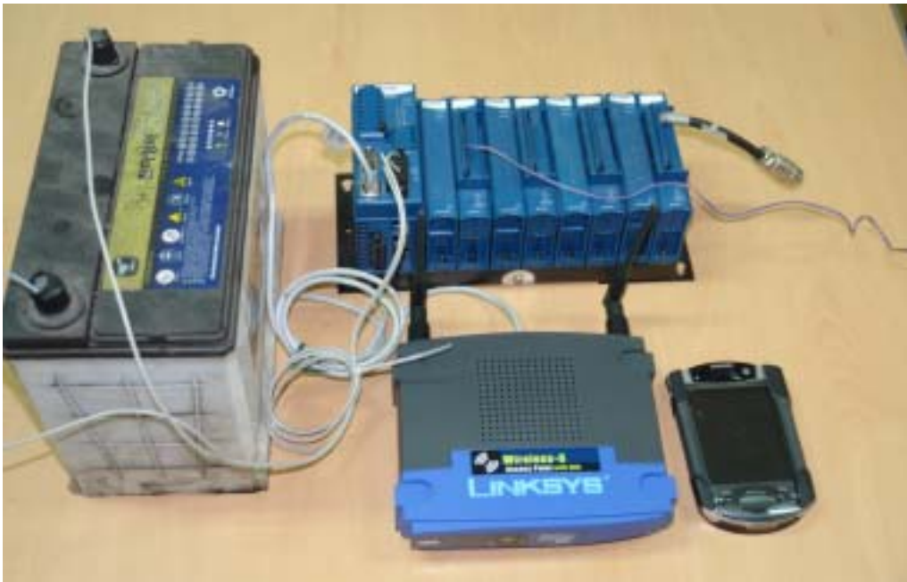
그림 3-1-80. 가선계 집재 시스템의 공정 계측을 위한 계측 시스템
