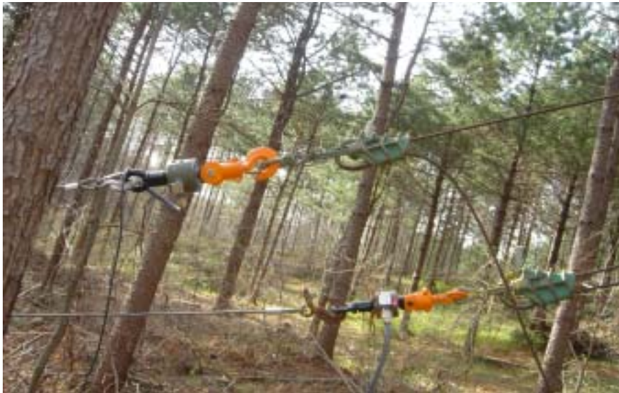
그림 3-1-44. 라디캐리 가선장력 측정을 위한 로드셀의 설치
