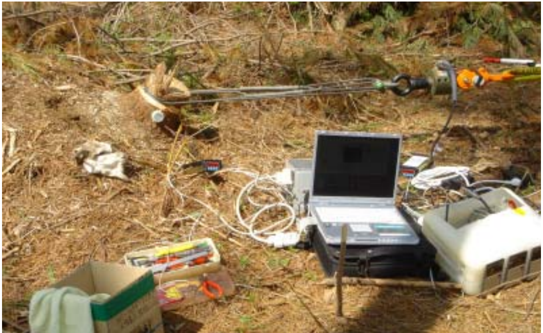
그림 3-1-49. 잣나무 근주강도를 측정하기 위한 센서 및 계측장치의 세팅
