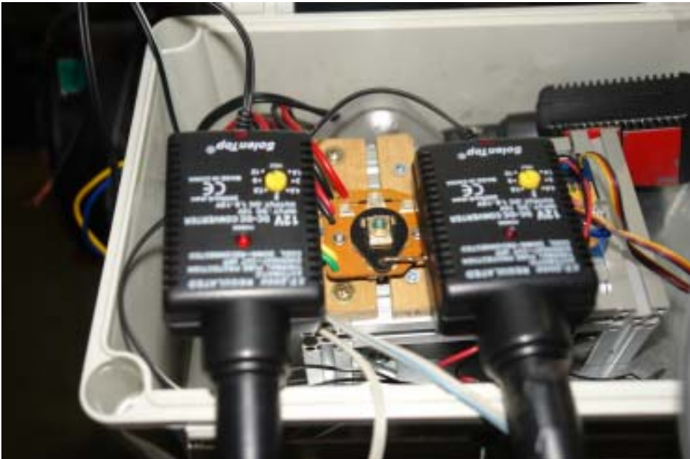
그림 3-1-32. 윈치의 정역회전 측정을 위한 센서의 배치 및 콘트롤 박스
