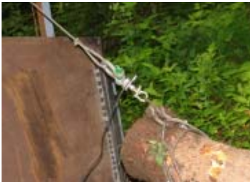
(a) 견인력 측정을 위한 loadcell
