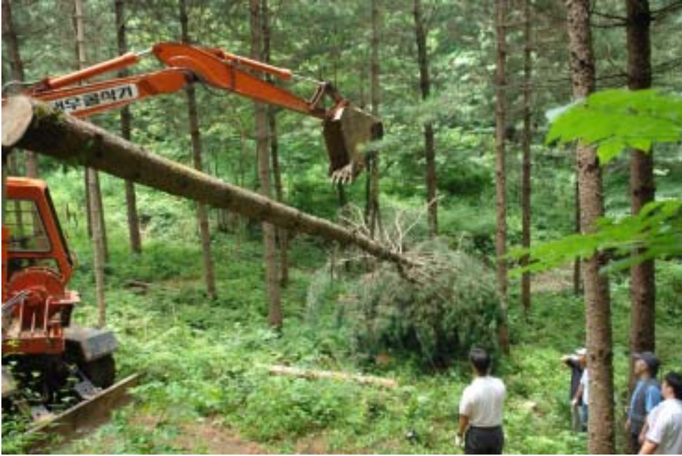
그림 3-1-98. 견인대상목의 중량과 무게중심위치의 측정
