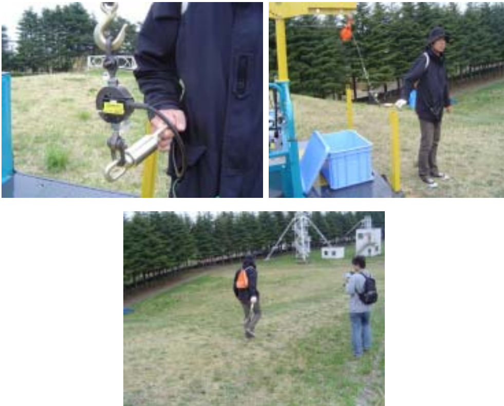
그림 3-3-2. 로드셀을 이용한 와이어로프 견인 장력 측정 실험의 전경
