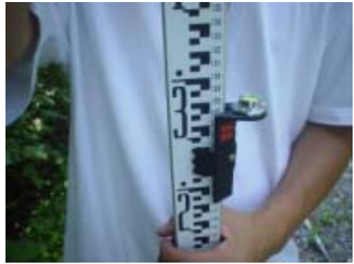
그림 3-3-22. 노면조도 측정을 위한 레벨 측량
