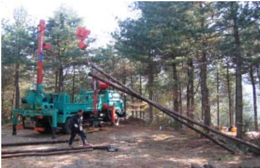
그림 3-3-11. 다목적 집재차량을 이용한 집재방법
