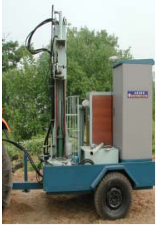
그림 2-26. 수직관입형 토양시료 채취 시험장치
