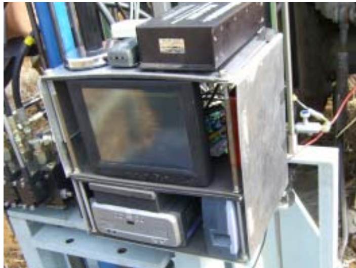
그림 2-33. 토양 분석용 시료 채취기 제어 장치
