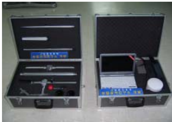
그림 2-47. 휴대형 토양 분석용 시료 채취기의 제작
