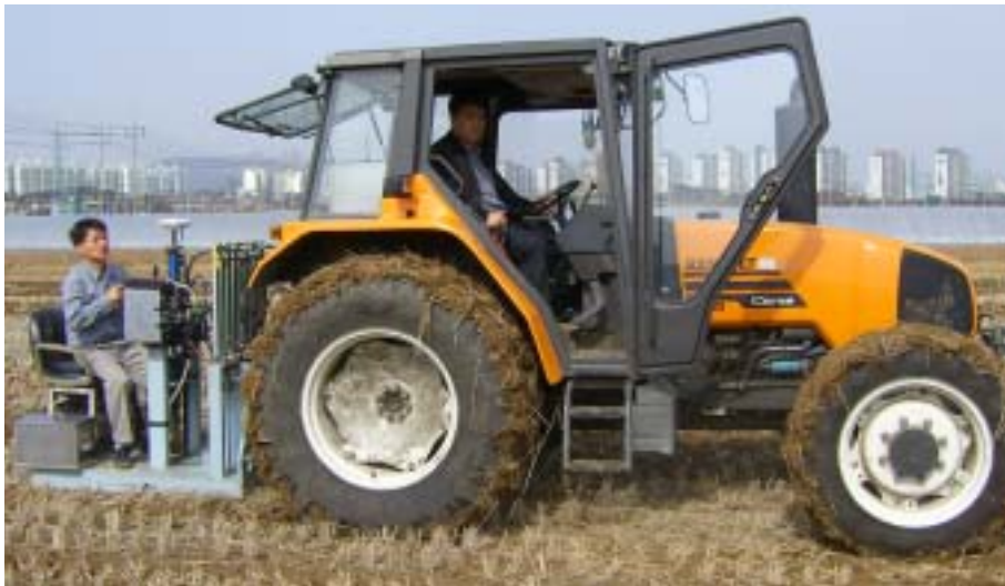
그림 2-43. 토양 분석용 시료 채취기의 포장시험 광경
