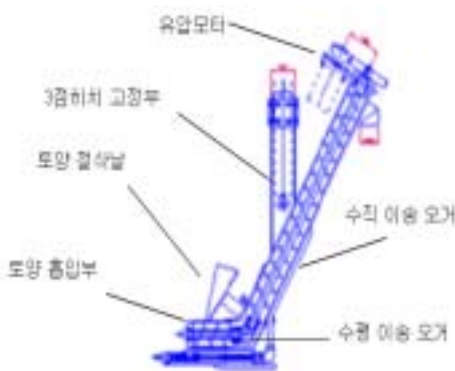
그림 2-27. 수평견인형 토양 시료채취 시험 장치
