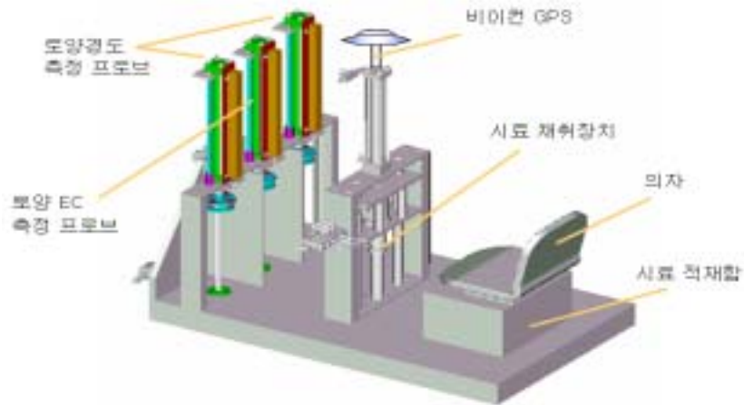
그림 2-34. 토양 분석용 시료 채취기 통합 완성도
