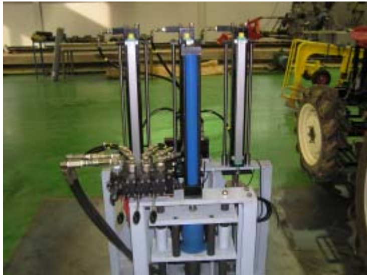
그림 2-29. 토양 분석용 시료 채취기의 유압 블록 구성>
