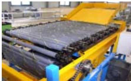
그림 3.3-19. 실험용 롤러타입 양파 줄기절단장치의 사진
