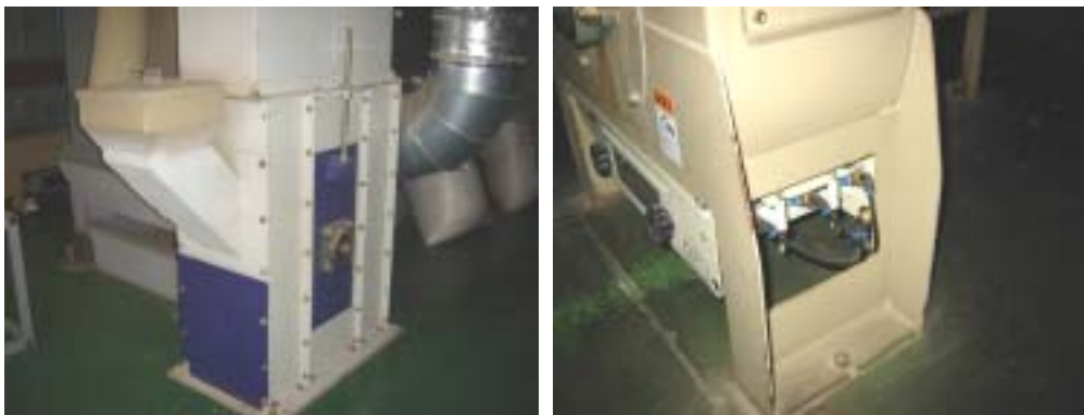
그림 3-7. 하부청소가 어려운 버킷엘리베이터(A)와 용이한 버킷엘리베이터(B)
