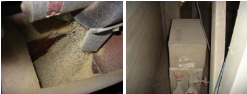
그림 3-6. 분진과 미강에 의해 불결해진 정미기 및 습식연미기 물탱크(예)
