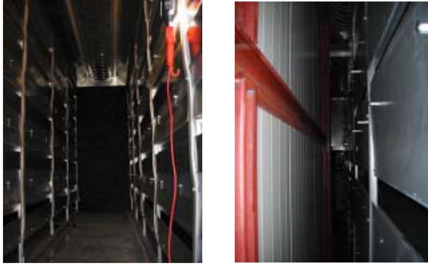
그림 3. 케이지를 기준으로 풍상측 입기용 슬릿 (a)와 풍하측 배기용 슬릿
