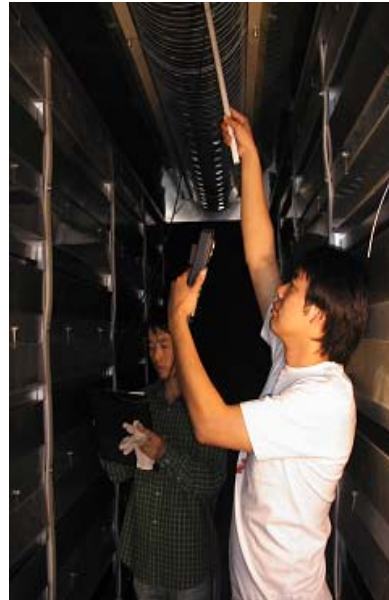
그림 3. Hot-wired anemometer를 이용하여 환기구에서의 공기유속 측정
