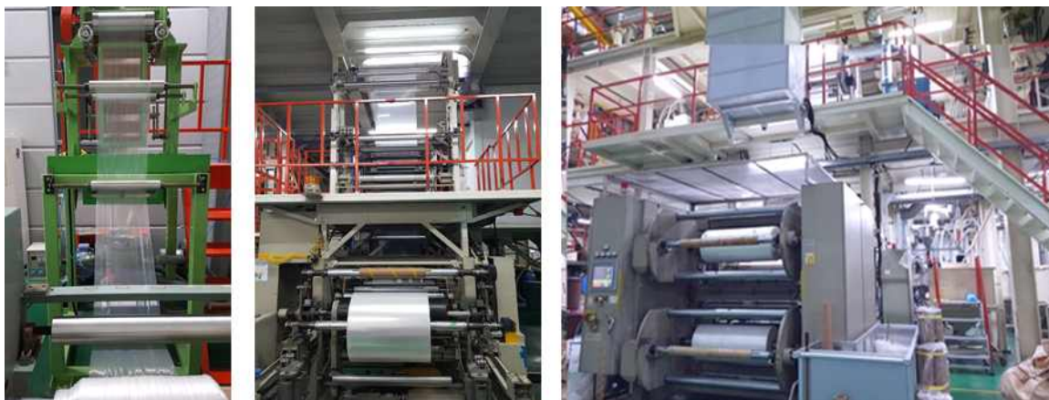
그림 2-001. 개발에 이용한 블로운 필름 제막 장비(좌: 단층, 중간 및 우: 다층)
