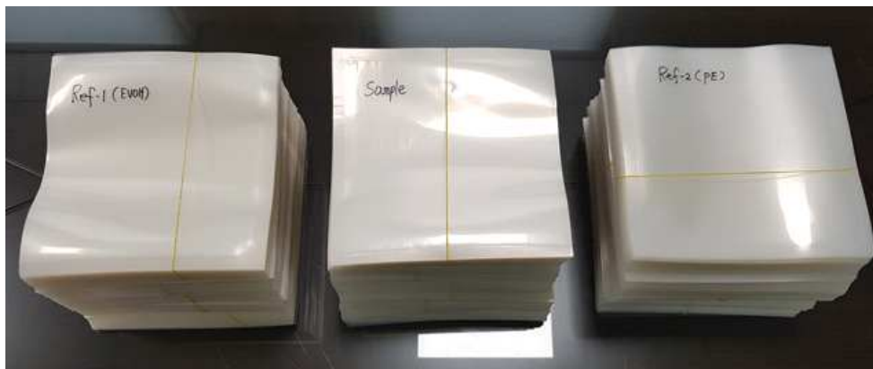
그림 2-050. C층 종류별 PET 합지 PE 필름 및 베리어 공압출필름 파우치 (C층 - 좌: PE, 중간: 폴리케톤 베리어, 우: EVOH)
