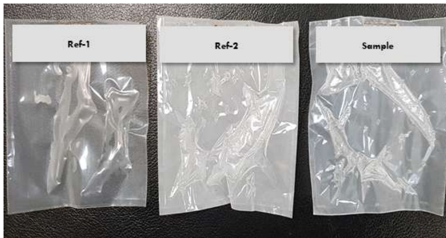
그림 2-052. C층 종류별 PET 합지 필름 시편의 레토르트 처리후 사진 (C층 - 좌: PE, 중간: EVOH, 우: 폴리케톤 베리어)
