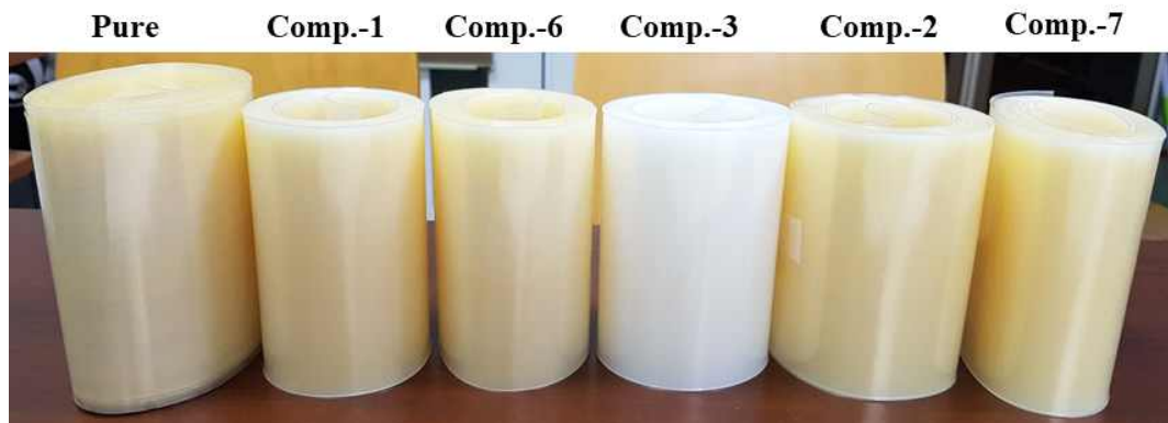
그림 1-28. 첨가제의 종류에 따른 modified 폴리케톤 다층 필름
