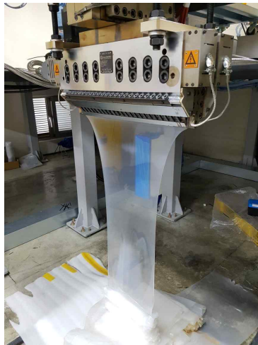
그림 4-10. KIST 전북분원 pilot scale 7-layer 공압출 필름 라인
