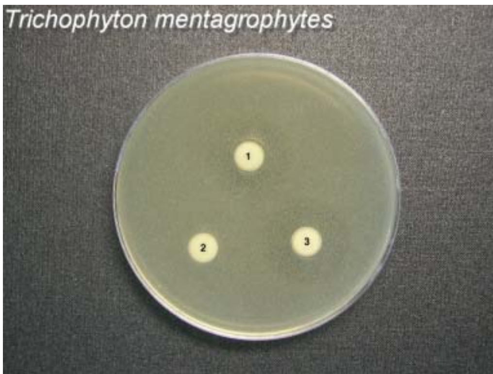
그림 13. 진균에 대한 천연 쪽 염료의 항균활성 (1; 천연 쪽 염료, 2; Blank, 3; 기존의 항균제)
