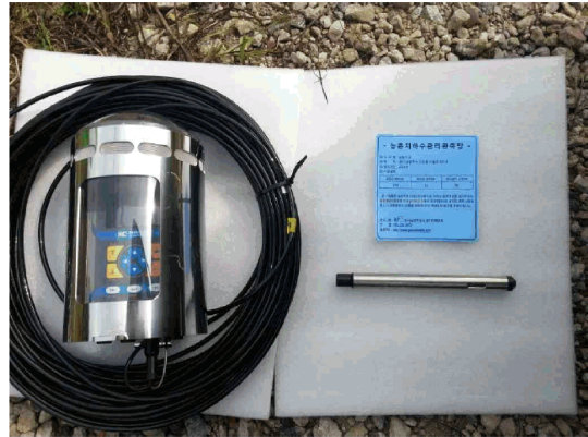
(b) 센서, RTU, 전원공급장치, 케이블 준비
