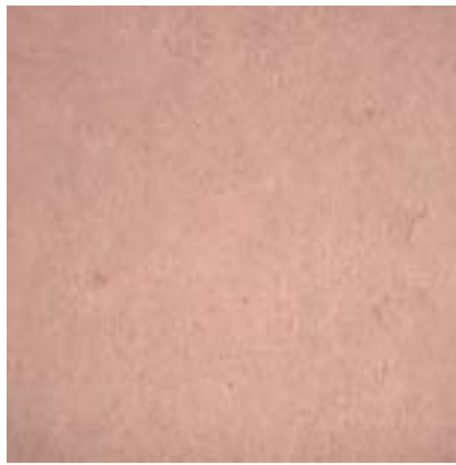
그림 1-27. 황토:목탄=80:20 비율의 복합관상제품의 표면상태
