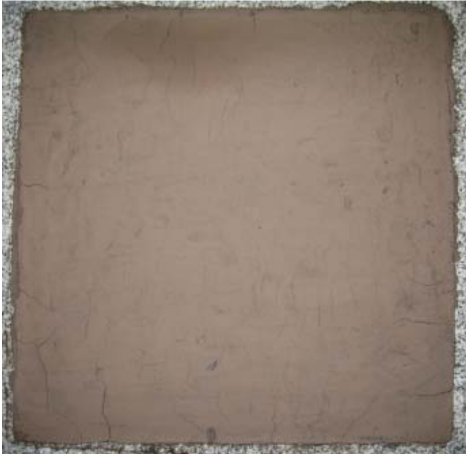
그림 1-6. 숯과 황토 체적비 1:1 혼합한 경우, 건조후의 판상시편의 표면 할렬
