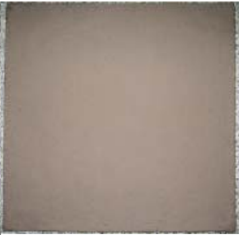
그림 1-5. 폐지섬유 5%첨가시 105°C로 고온건조후의 상태
