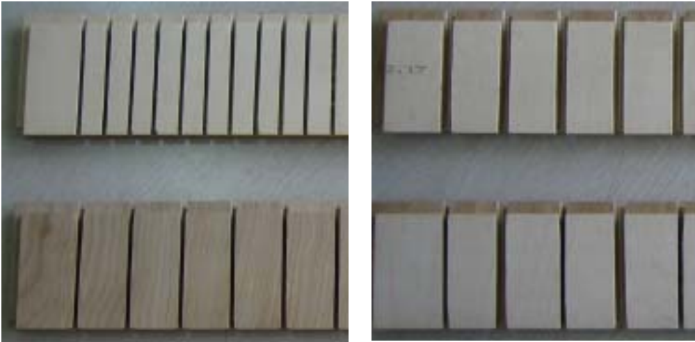
그림 1-16. 숯 주입정착을 위한 목재마루판 뒷면의 흠모양 정비(4종류)
