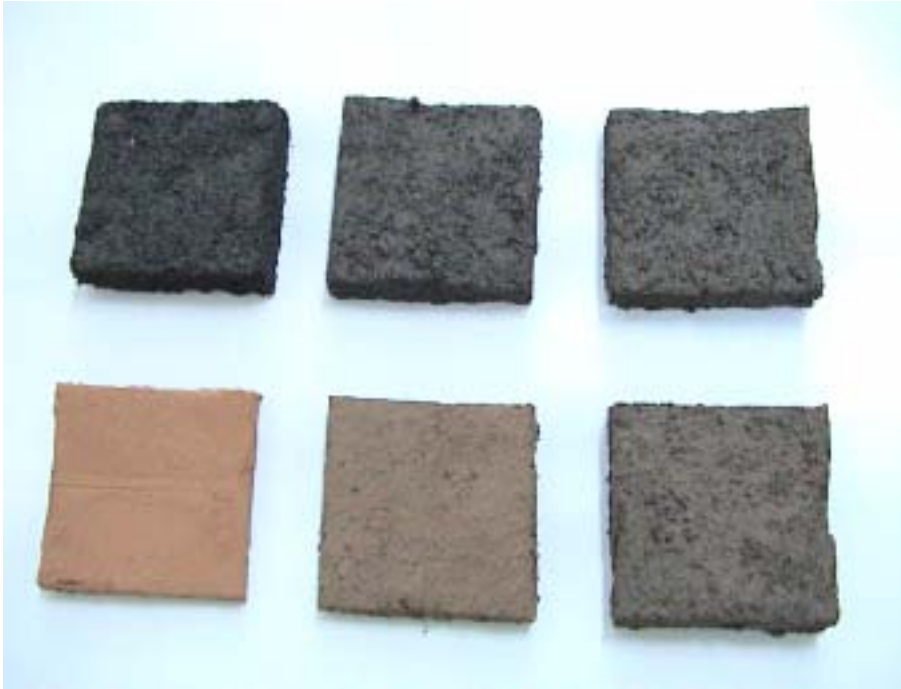
그림 1-7. 황토를 매개체로 한 목탄계 복합보드의 외관상태 [목탄과 황토의 체적배합비율. 상단: 80:20(좌), 60:40(가운데), 50:50(우), 하단: 0:100(좌), 20:80(가운데), 40:60(우)]
