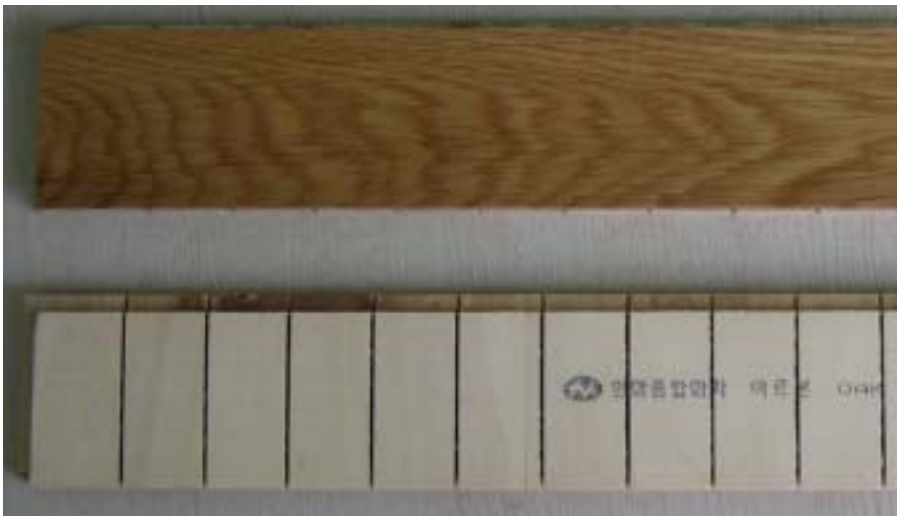
그림 1-15. 실험제공용 시판 마루판(한화종합화학, 표층두께4mm, 10(t)×70×600 참나무합판마루)
