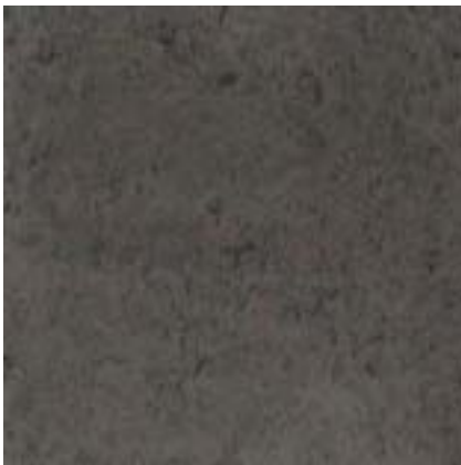
그림 1-8. 황토: 목탄=40:60 비율의 복합판상제품의 표면상태
