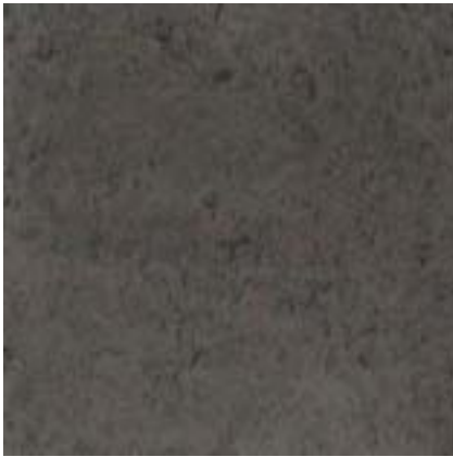
그림 1-26. 황토:목탄=40:60 비율의 복합관상제품의 표면상태
