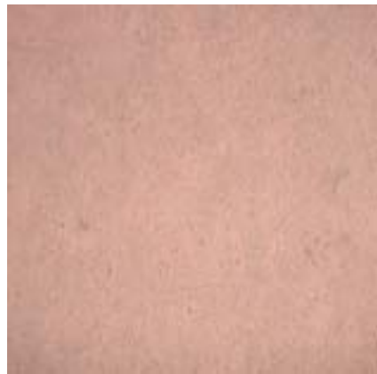
그림 1-9. 황토 : 목탄=80:20 비율 의 복합판상제품의 표면상태
