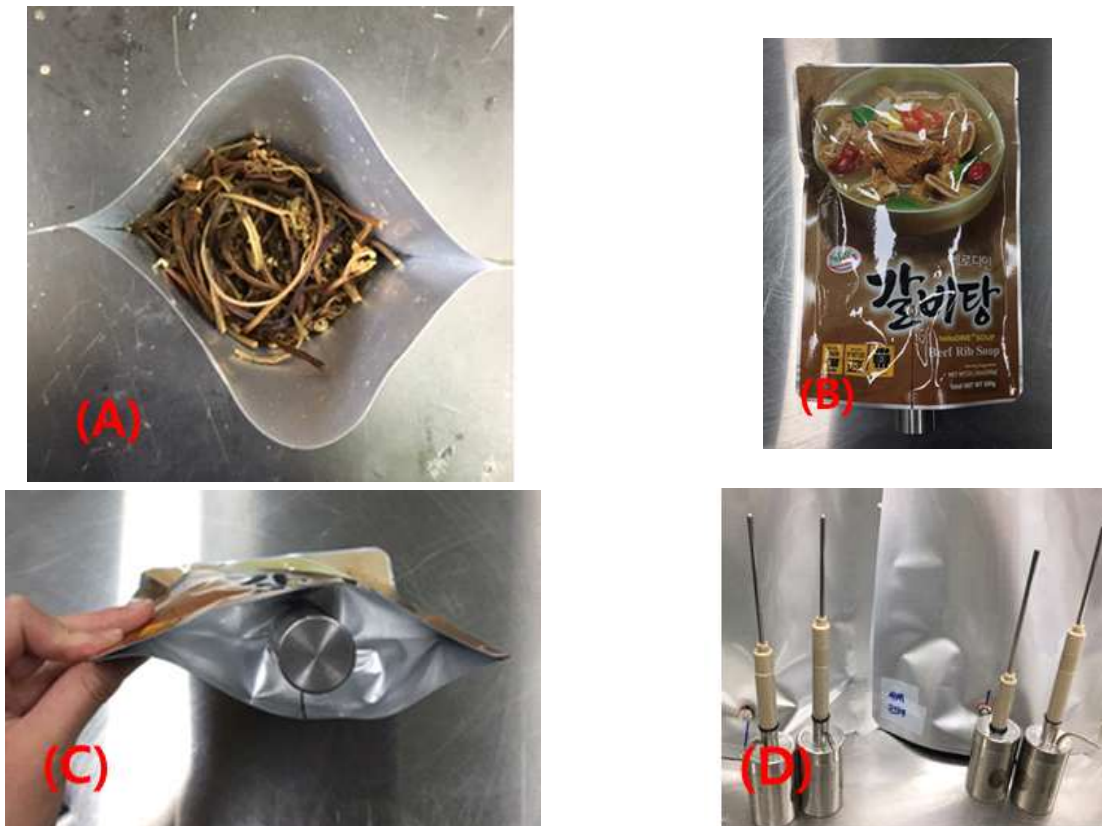
Fig 18. 살균도 도출을 위한 나물의 온도측정 방법
