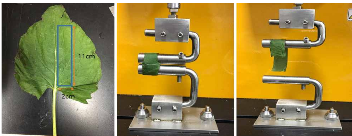
Fig 2. 생곤드레의 조직감 측정 방법
