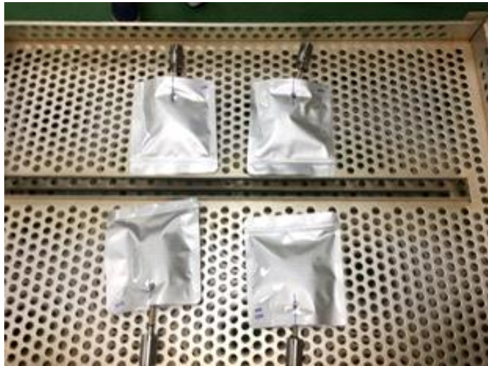
Fig 26. 강릉과학산업진흥원 레토르트의 이용 시 고사리와 곤드레의 F-value 측정
