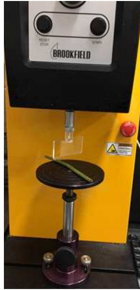
Fig 1. 생고사리의 조직감 측정 방법
