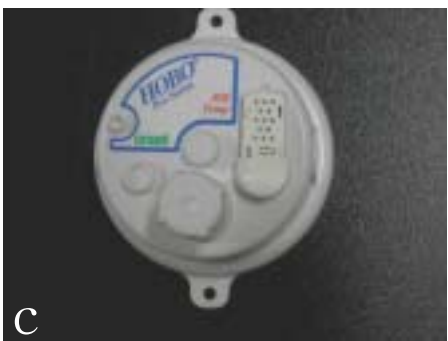
그림 17. HOBO, Measuring instrument for temperature and relative humidity(c)
