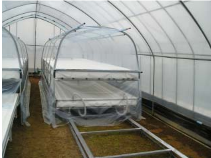
그림 4-4. 2단 벤취 시스템과 하단 베드 이동용 레일
