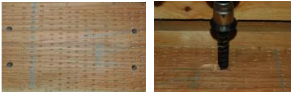
<그림 6-4> 예비천공(좌) 및 스파이크 인발저항력 측정 시험을 위한 스파이크 박기(우)
