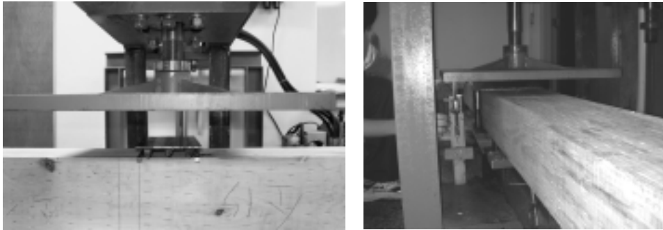
<그림 5-1> 침엽수재 침목의 자상처리(좌) 및 횡압축 처리(우)
