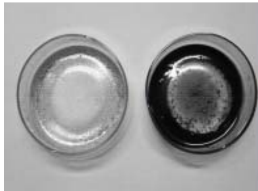
<그림 3-3> 크레오소오트유 추출 농축액 (좌: 목재 추출물 농축액, 우: 목재 추출물과 크레오소오트유 혼합 농축액)
