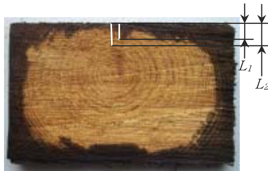
<그림 3-1> 크레오소오트유 침윤도 측정 방법
