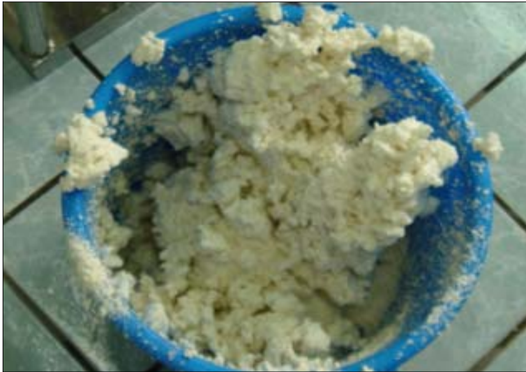
Fig. 52. 현장적용시스템을 통하여 생성된 액상포말-미생물담체
