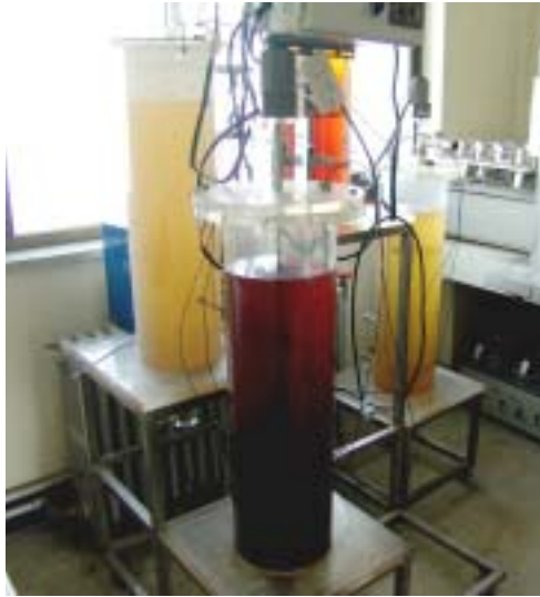
그림 1. Bioreactor를 이용한 광물성 및 식물성 추출액의 온도별 숙성과정 (좌에서 우로 : 15℃, 20℃, 25℃, 30℃)
