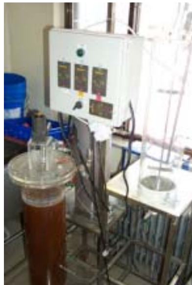
그림 2. 광물성 및 식물성 추출액의 bioreactor를 이용한 혼합숙성과정
