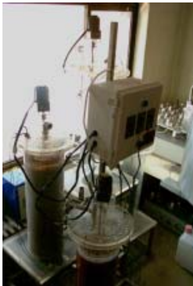
그림 2. 광물성 및 식물성 추출액의 bioreactor를 이용한 혼합숙성과정
