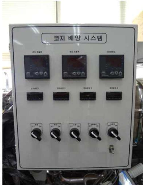
Fig. 55. 코지 배양 시스템의 제어장치(모델2)
