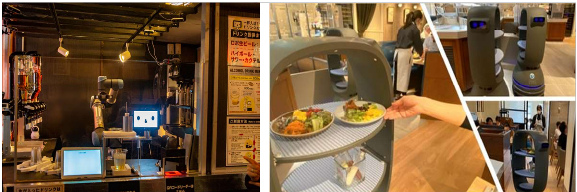
[그림 6-12] (좌)주문을 받는接客 로봇 / (우)음식점 내에 활용되고 있는 서빙 로봇
