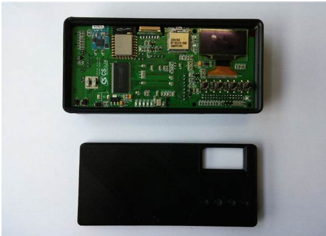
그림 83. 출력 완료한 일체형단말기 외형 기구
