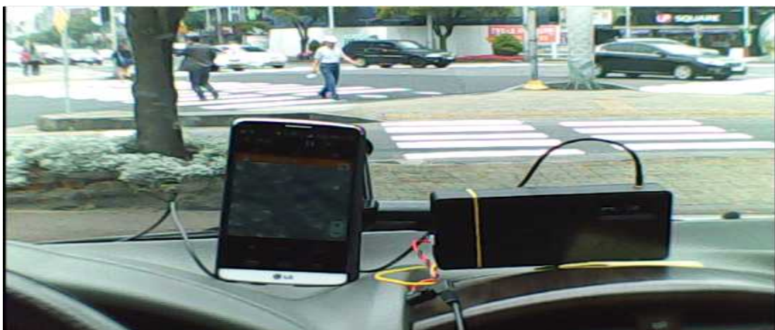
그림 137. 일체형단말기와 안드로이드 디바이스 차량 설치 사진
