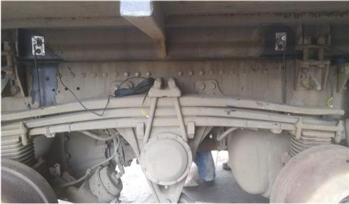
그림 175. 20톤 차량 중량 센서 뒷부분 4개소 설치
