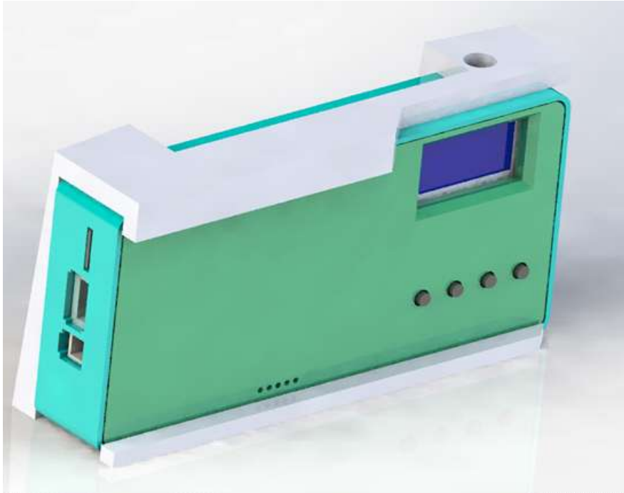
그림 89. 전면 유리 부착형 거치대 3D 렌더링(후면)
