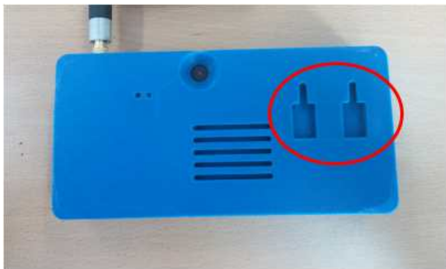
그림 114. 일체형단말기 케이스의 거치대 결합부
