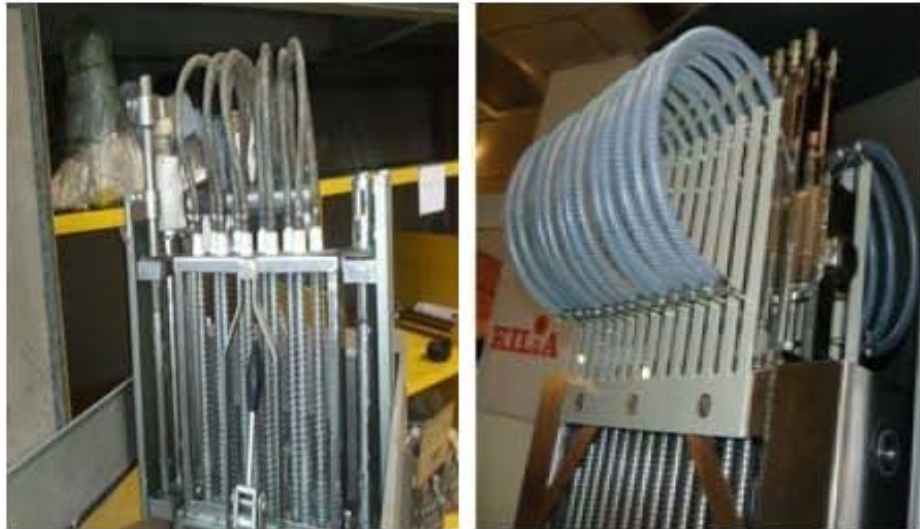
그림 1. 수입 인젝터 Needle 구조
