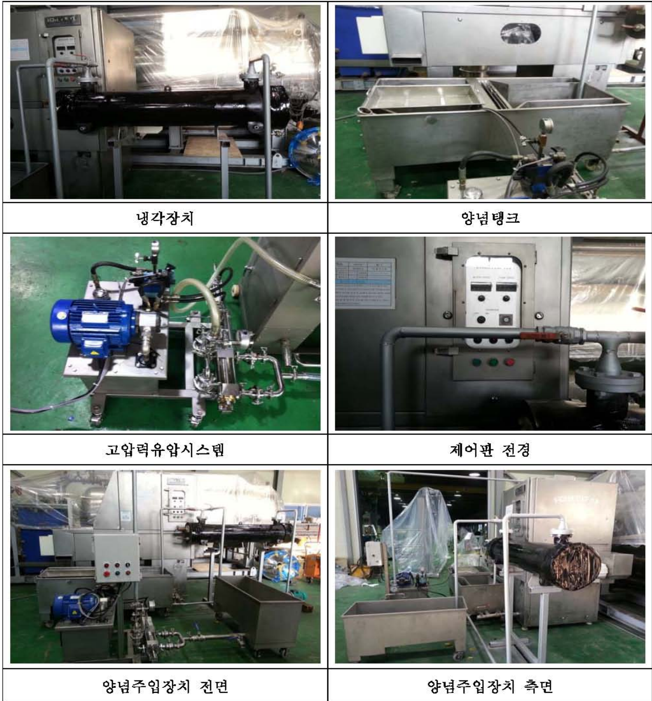
그림 27. 양념주입장치 제작 과정
