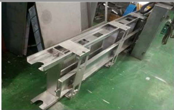
Convey belt flame 구조 용접처리완료
