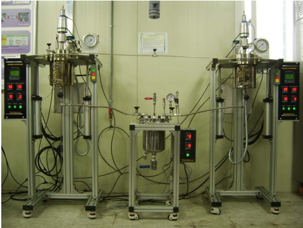
그림 3-46. 직접 열교환형 열수분해 반응기 운전 사진
