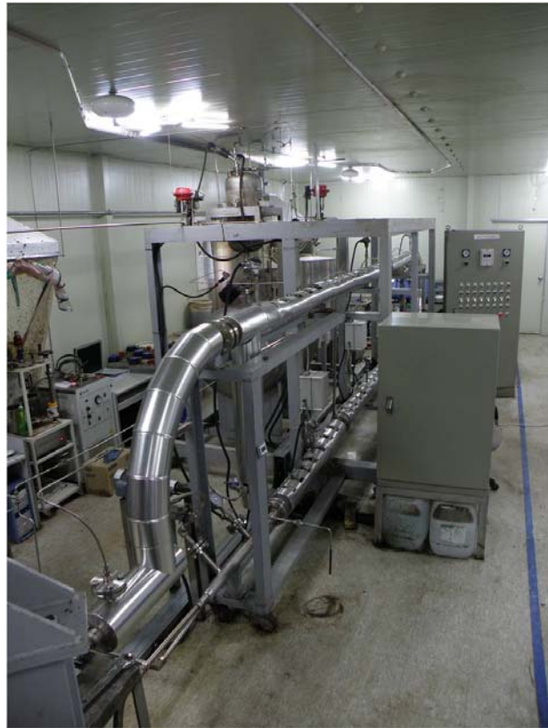
그림 3-36. 관형 열수분해 반응기 사진
