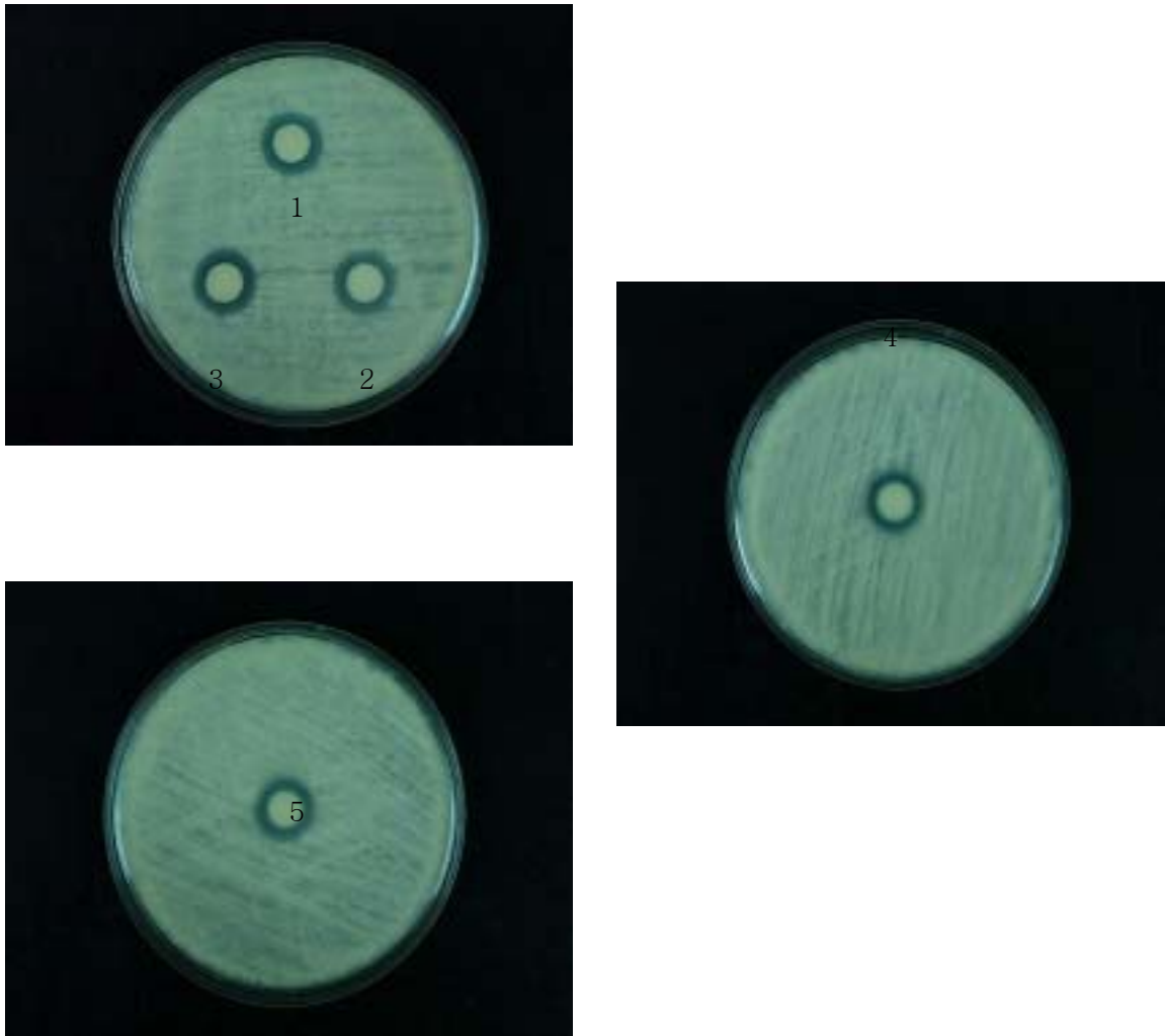
Fig. 9. Ca-2 ( Rhizopus oryzae )균에 대하여 초음파 처리한 chitosan 용액을 분자량 별로 나누어 agar diffusion assay 한 결과
