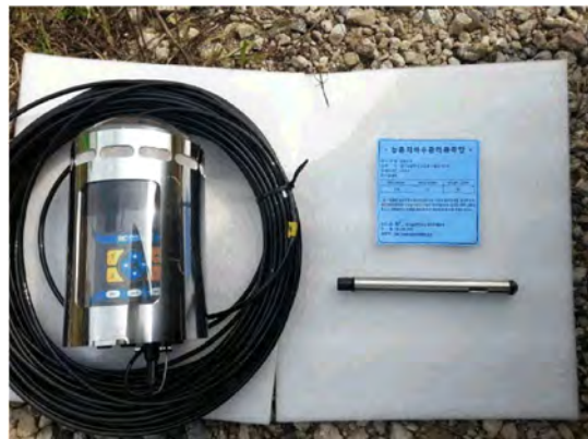
(b) 센서, RTU, 전원공급장치, 케이블 준비
