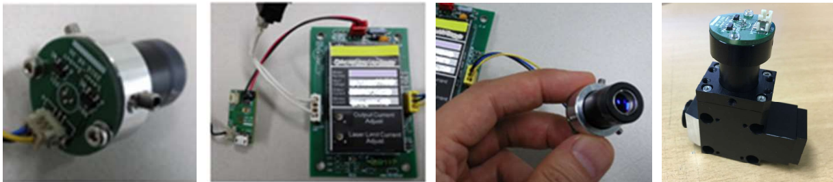
그림 2-18. 다이오드 레이저 드라이버와 컨트롤러 모듈, 제작된 광원부
