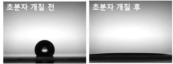
그림 2-25. 초분자 표면개질 정량평가 및 접촉각 테스트 결과
