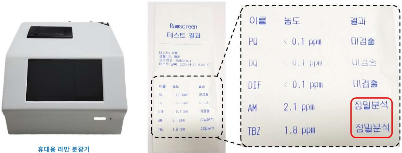
그림 2-100. 휴대용 라만 분광기를 이용한 농약 검출 테스트 결과
