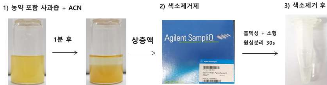
그림 2-96. 사과 내 유기계 농약 전처리 테스트 실시예
