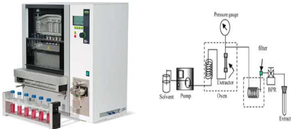
그림. 고속 용매 (accelerated solvent extractor; ASE) 추출기 (좌), 가압액체 추출법 원리 (우)
