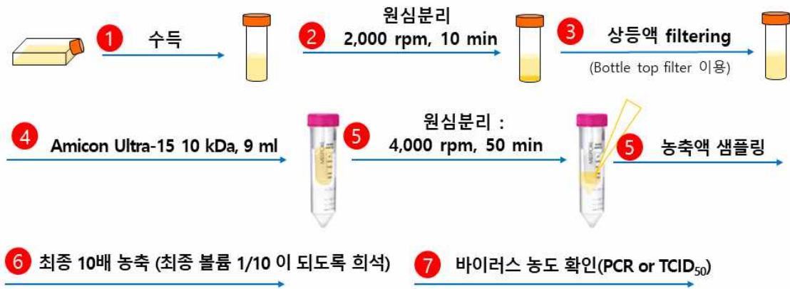
그림 6 . PK15 세포주로부터 분리된 PCV1 바이러스의 농축방법 모식도.
