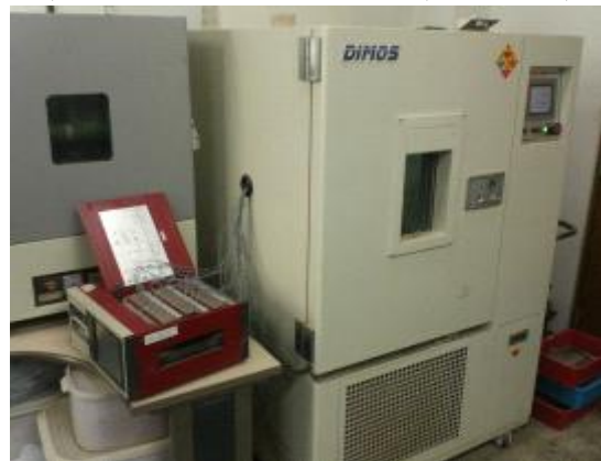
6) 데이터 로거를 이용한 변형률 측정
