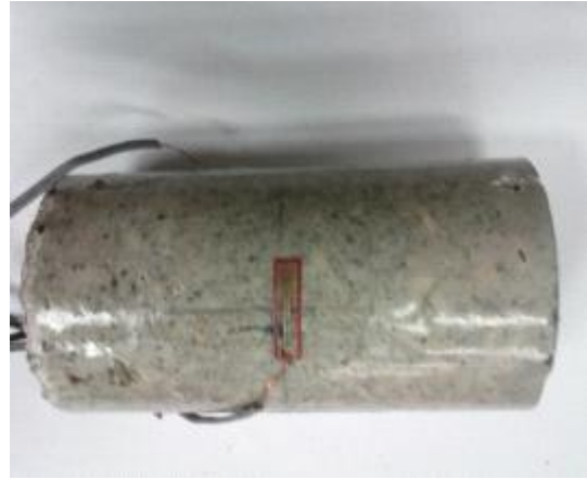
2) 포아슨비 시험용 스트레인 게이지 부착(10 mm)
