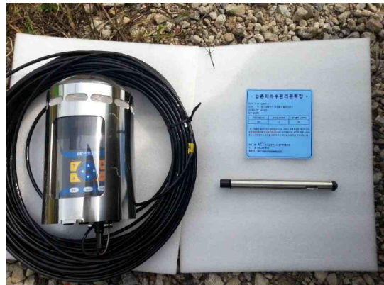
(b) 센서, RTU, 전원공급장치, 케이블 준비
