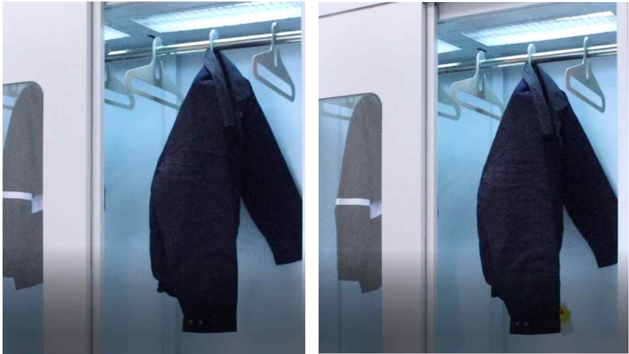
그림 68. 옷을 걸은 상태에서 좌우로 흔들며 살균이 진행되는 모습
