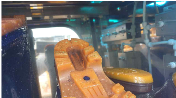
그림 80 장화 살균기 내부 (자외선 램프 및 노즐의 설치)
