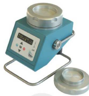
그림 17. 유기물 조건 부유 세균 살균 실험 장치. 네블라이저 및 에어샘플러
