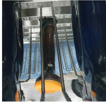
그림 75. 세균 담체( salmonella disk carrier)를 이용한 살균 실험
