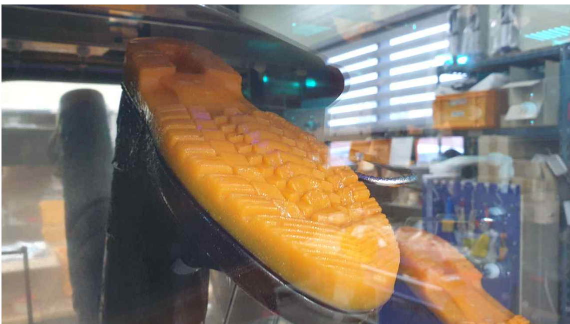
그림 81. 제작한 장화 살균기를 이용한 유기물 조건에서 AI 바이러스 소독 실험
