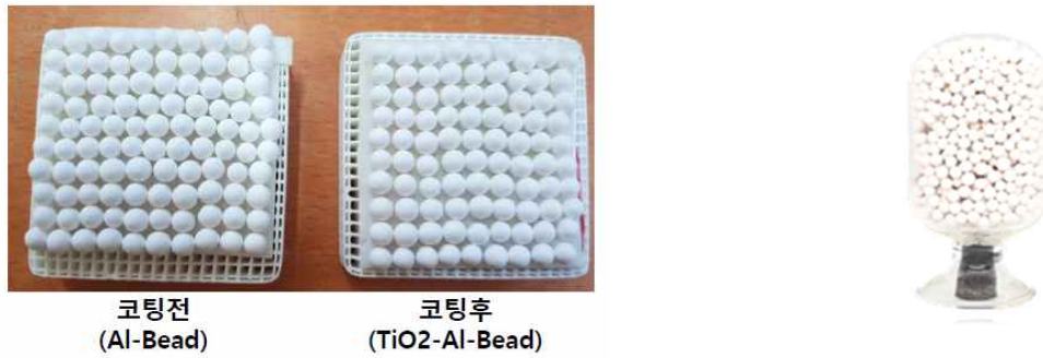
그림 62. 세라믹 BEAD에 광촉매를 코팅하여 고정화 한 최종 촉매
