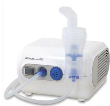
그림 17. 유기물 조건 부유 세균 살균 실험 장치. 네블라이저 및 에어샘플러
