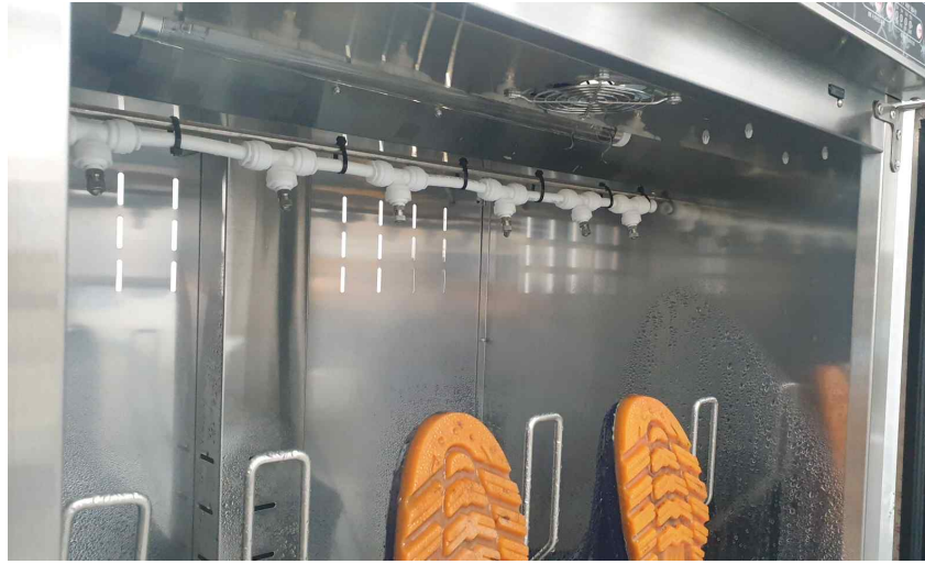
그림 72. 차아염소산 분사 노즐을 설치한 모습
