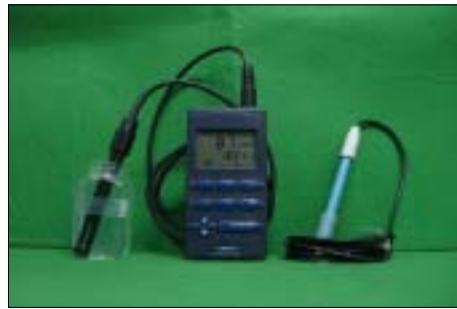
그림 3-4-5. pH·EC 측정기(좌 : inoLab Level 3 of WTW co, 우: pH/Cond 340i of Multi-parameter instrument Co)
