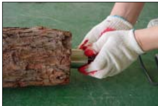
그림 3-5-1. 초음파 시험기를 이용한 영계수 측정
