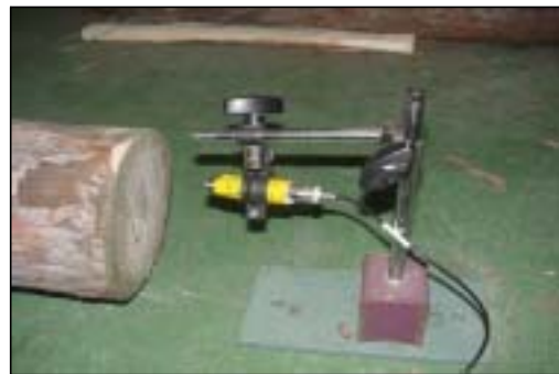
그림 3-5-2. 종진동의 고유진동수를 이용한 영계수 측정
