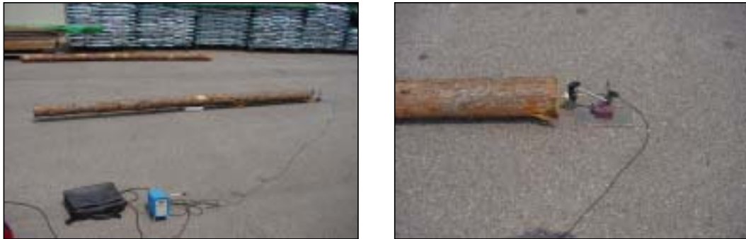
그림 3-8-5. 종진동의 고유진동수 측정
