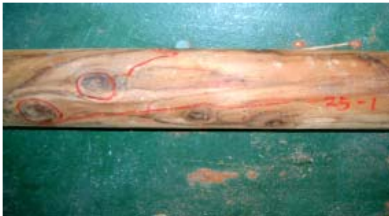
그림 3-8-26. 방부 처리 원주목의 파괴형상(LC-5)
