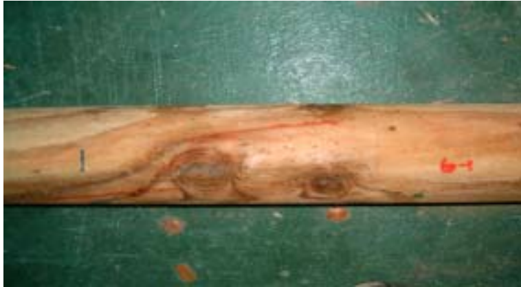
그림 3-8-22. 방부 처리 원주목의 파괴형상(LC-1)
