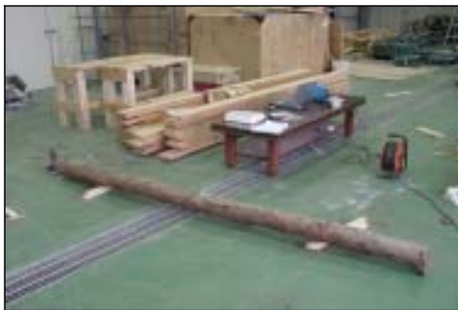
그림 3-5-2. 종진동의 고유진동수를 이용한 영계수 측정
