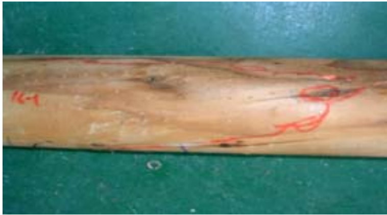
그림 3-8-23. 방부 처리 원주목의 파괴형상(LC-2)
