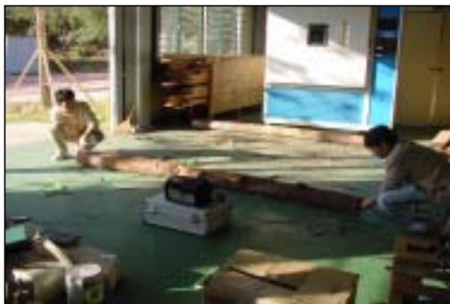
그림 3-5-1. 초음파 시험기를 이용한 영계수 측정
