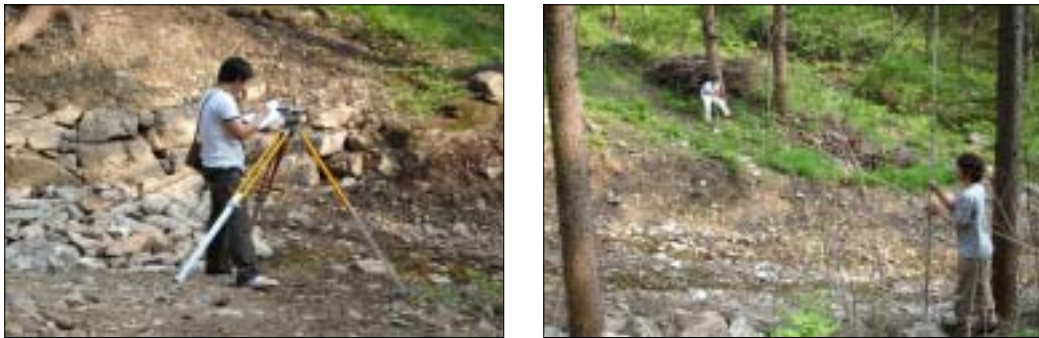
그림 3-4-1. 레벨을 이용한 정점측량 실시
