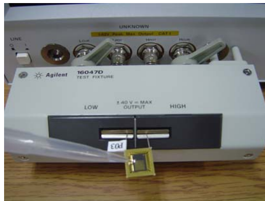
그림 3.1-18. Measuring impedance of the sensor in PBS buffer.
