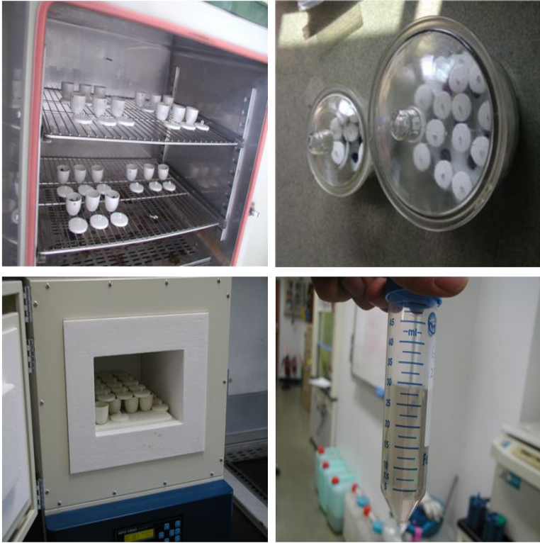
그림 2. Dry oven에서 수분, 회화로에서 회분, 50% HCl 용액으로 무기질 샘플 준비.
