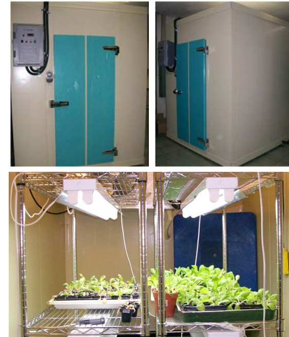
그림 27. 내서성 및 내한성 검증 장비.
