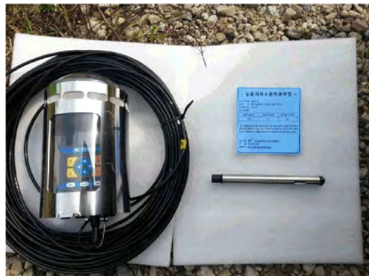
(b) 센서, RTU, 전원공급장치, 케이블 준비
