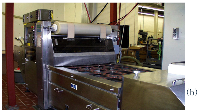
Fig. 27: 스트레치 포장기(b, Lidstock Equipment, Sealed Air사)를 이용하여 포장한 닭고기(a).
