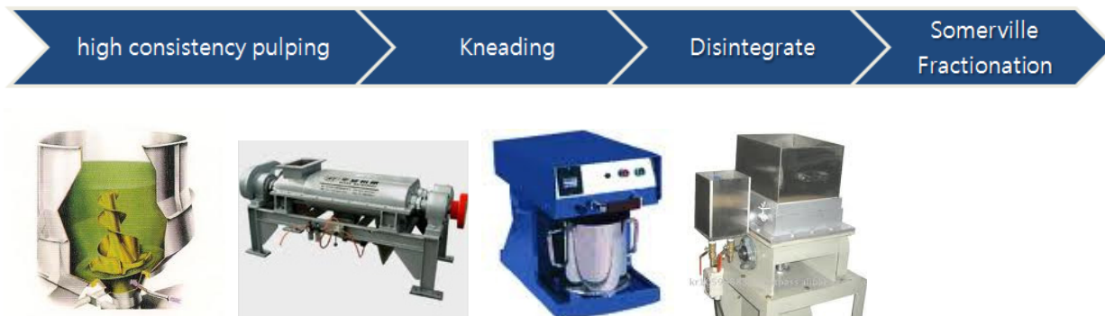
Fig. 23. 왕겨의 물리적 처리 공정의 모식도
