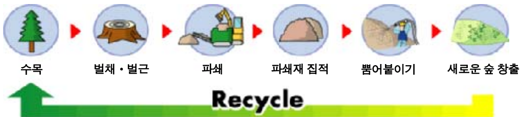
그림 3-1-12. 식물유도뽐어붙이기공법의 공정 흐름도
