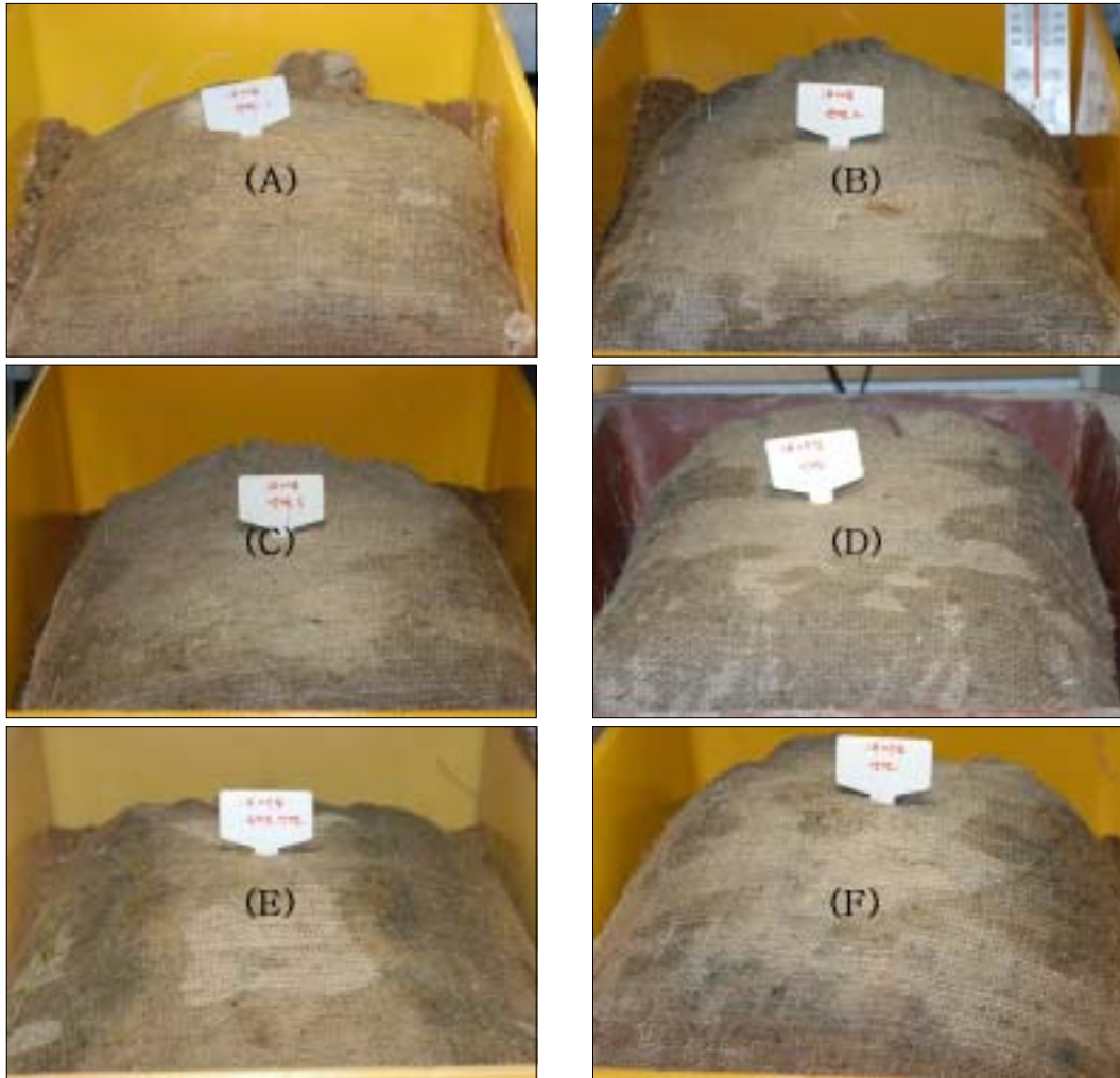
그림 3-2-9. 양면 거즈 내피 마대에 있어서 6일경과 후의 발아개시 모습 (상, 중 : 양면 종자부착마대, 하 : 단면 종자부착마대)
