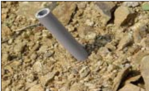
그림 3-4-59. 완경사지 및 급경사지의 토양침식 측정용 파이프
