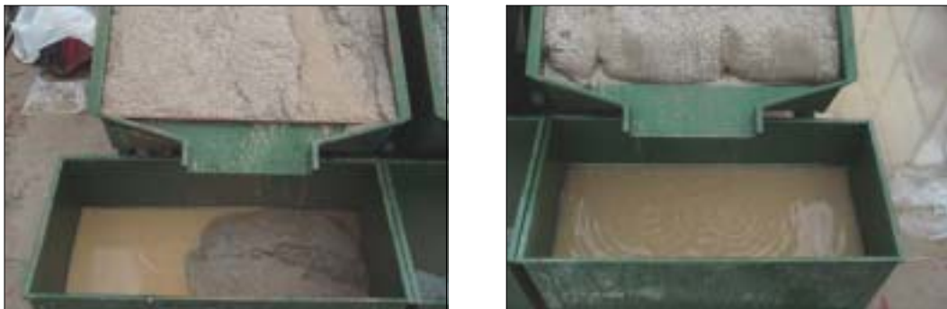
그림 3-3-6. 라이시미터 최하단부에 설치한 집수정과 토사유출 상황
