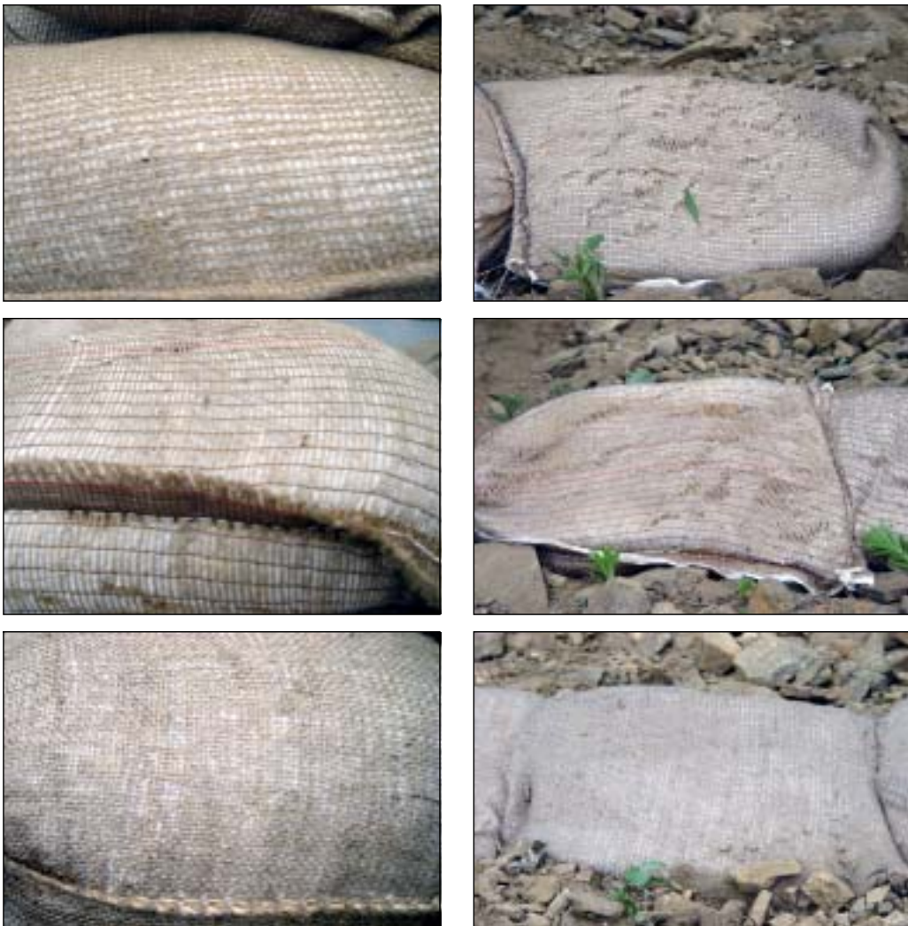
그림 3-4-22. 시공 시 마대 내피의 파손 경향(상 : L마대, 중 : R마대, 하 : D마대)
