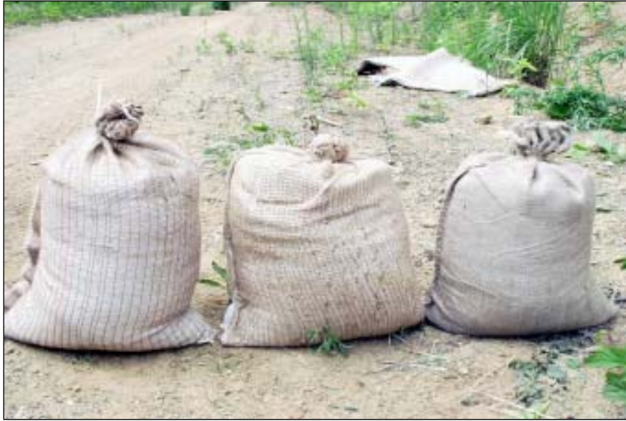
그림 3-4-23. 내부 충전 후의 마대 상태(좌 : R마대, 중 : L마대, 우 : R마대)
