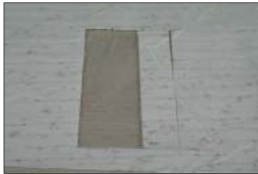
그림 3-2-19. 인열강도 실험용 마대의 시편 제작상황
