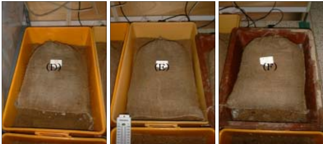
그림 3-2-8. 양면(좌), 줄모양 단면(중) 및 단면(우) 종자부착마대 발아실험
