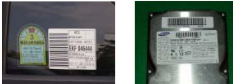
그림 47. 바코드에 의한 자동차 및 하드디스크의 제조번호 관리 예
