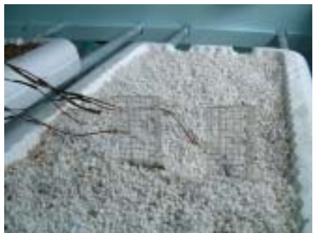
(c) 배지(펄라이트)내 온도센서 설치
