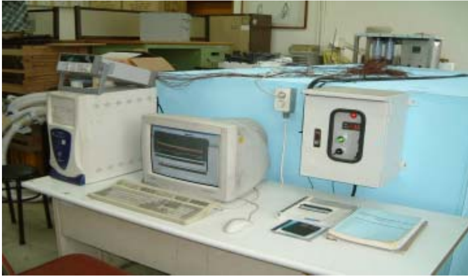
그림4-17 온실내 온도변화에 따른 배지온 변화 시험장치
