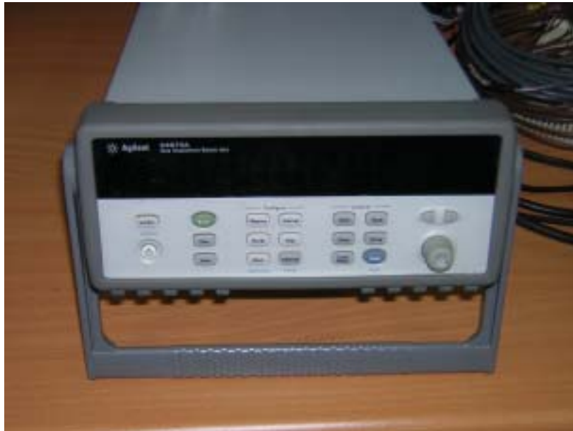
그림4-20 온도변화 측정 데이터 로그 장치(Hewlett Packard)
