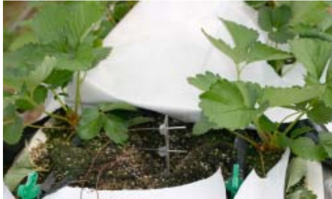
그림4-47 고설재배 시스템에서의 온도센서 설치
