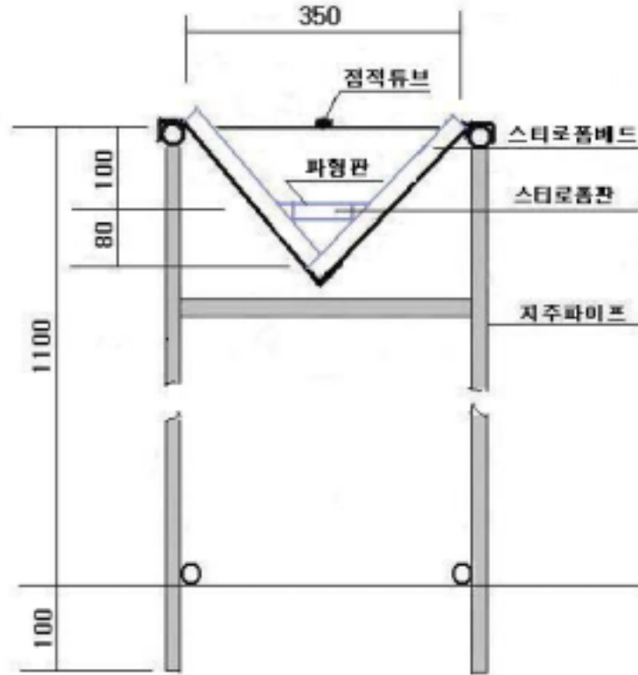
그림4-55 스티로폼판 V형베드 주체 고설재배 시스템
