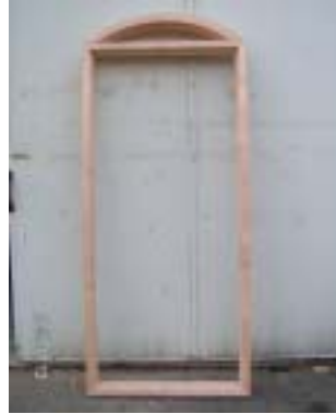
Photo 5-15 만곡 집성재를 이용한 문틀의 제작(수성비닐우레탄 사용)
