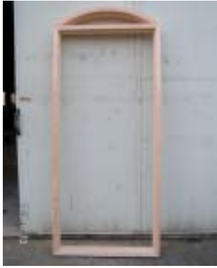
Photo 5-15 만곡 집성재를 이용한 문틀의 제작(수성비닐우레탄 사용)
