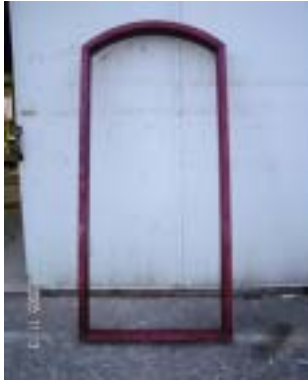
Photo 5-17 제작된 만곡집성재 문틀의 도장 과정 및 도장처리된 문틀
