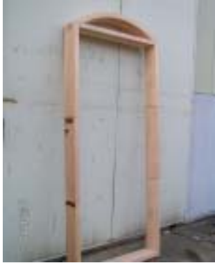
Photo 5-15 만곡 집성재를 이용한 문틀의 제작(수성비닐우레탄 사용)
