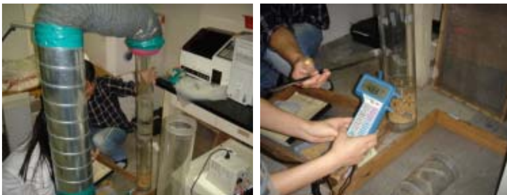
그림 17. 공기방향을 흡입으로 하여 벼의 선별특성을 측정하는 장면
