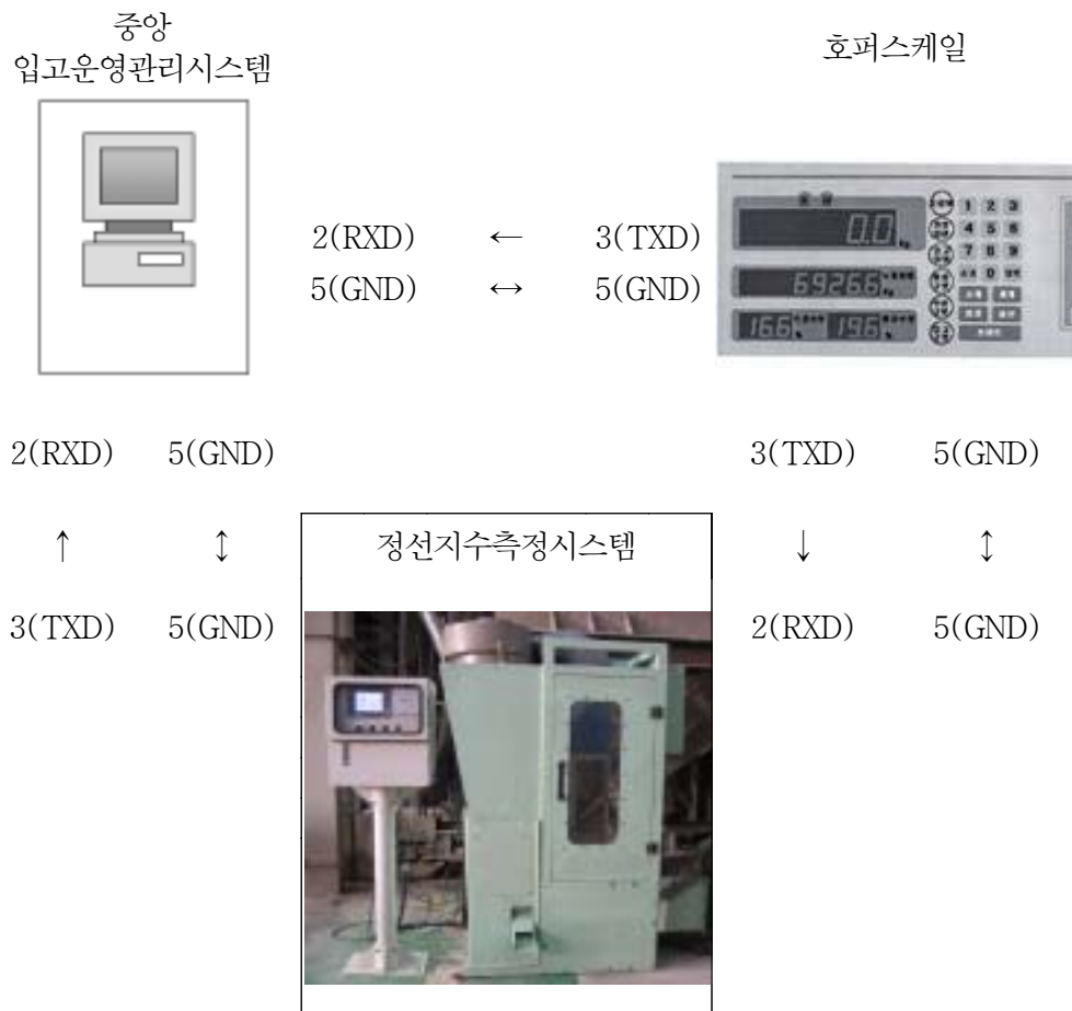
그림 34. RPC에서 정선지수측정 측정 종합체계의 통신흐름도
