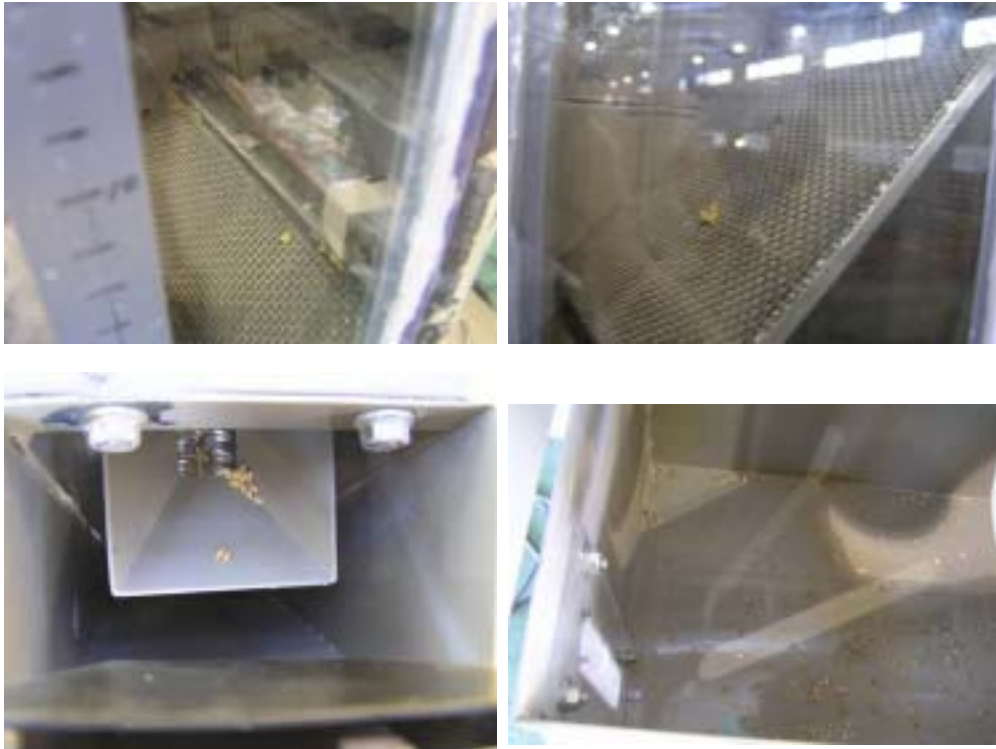
그림 31. 선별체 등에 끼어 있는 벼 낱알 및 공기층만실에 낙곡이 발생한 모습
