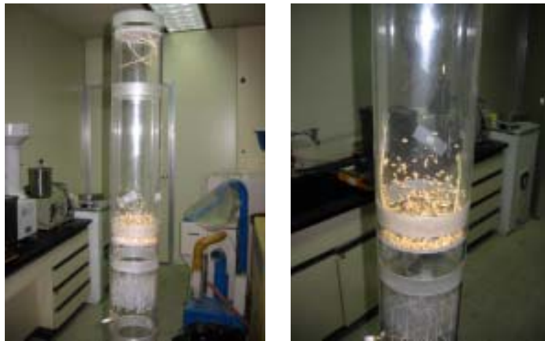
그림 15. 풍동을 이용한 지푸라기 형태별 선별장면
