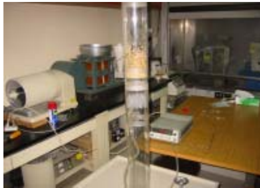
그림 8. 시제품으로 제작된 풍동과 풍동내에서 선별장면
