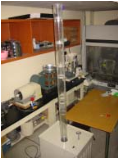
그림 8. 시제품으로 제작된 풍동과 풍동내에서 선별장면
